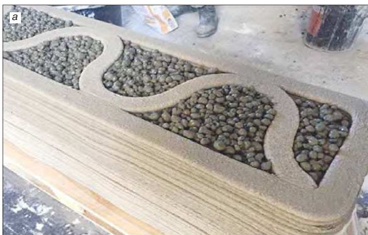
Рис. 2. Крупноразмерные образцы (фрагменты стен), напечатанные на 3D-принтере: а – с заполнением крупнопористым керамзитобетоном; б – с заполнением пеногипсом Fig. 2. Large-sized samples (wall fragments), printed on a 3D printer: а – filled with large-porous expanded clay concrete; б – filled with foam gypsum
