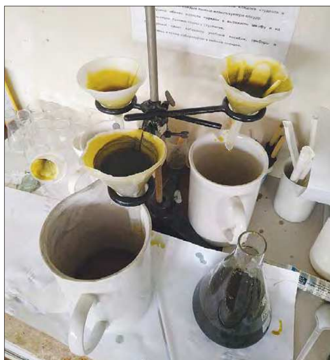
Рис. 2. Фильтрация окисленного графита Fig. 2. Filtration of oxidized graphite
