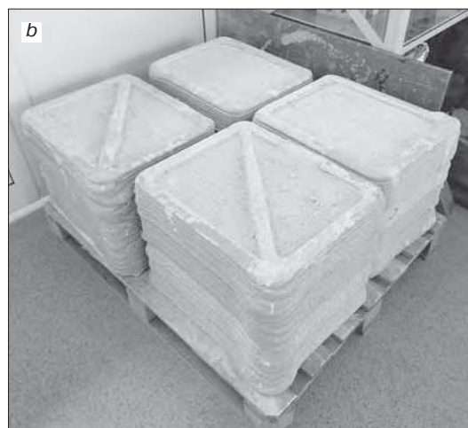
Рис. 2. Крупноразмерные образцы (фрагменты стен), напечатанные на 3D-принтере: а – с заполнением крупнопористым керамзитобетоном; б – с заполнением пеногипсом Fig. 2. Large-sized samples (wall fragments), printed on a 3D printer: а – filled with large-porous expanded clay concrete; б – filled with foam gypsum
