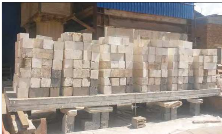
Рис. 5. Испытание конструкции перекрытия из монолитного пеногипса по ЛСТК-профилям
