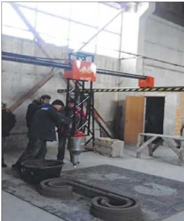
Рис. 1. Строительный 3D-принтер в процессе печати малых архитектурных форм Fig. 1. Construction 3D printer in the process of printing small architectural forms
