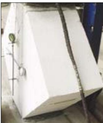
Рис. 2. Испытание на диагональное сжатие
