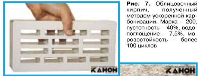
**Рис. 7.** Облицовочный кирпич, полученный методом ускоренной карбонизации. Марка – 200, пустотность – 40%, водопоглощение – 7,5%, морозостойкость – более 100 циклов
