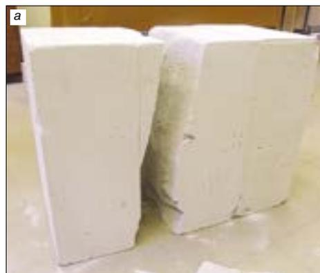
Рис. 3. Характер разрушения образцов кладки при сдвиге в плоскости горизонтальных швов: а – на полиуретановой клей-пене; б – на полимерцементном растворе
