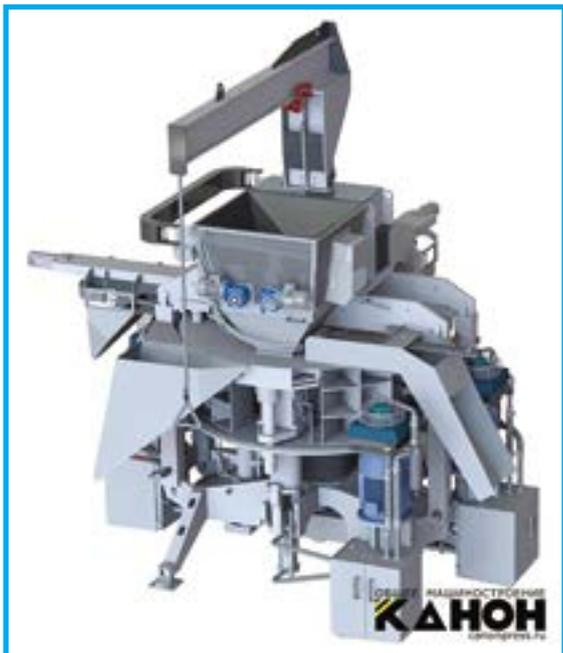
Рис. 4. Автоматический 4-позиционный револьверный пресс полусухого прессования П3200-Патриот
