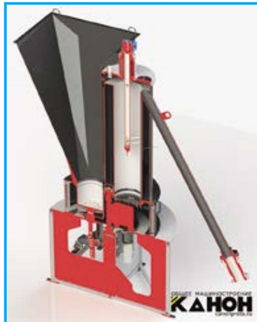
Рис. 6. Разрез печи прямого обжига «Вулкан»
