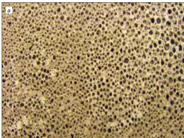
Макроструктура (а) и микроструктура (б) пенобетона марки по средней плотности D400 (состав 6, из таблицы) после ТВО в возрасте 28 сут
