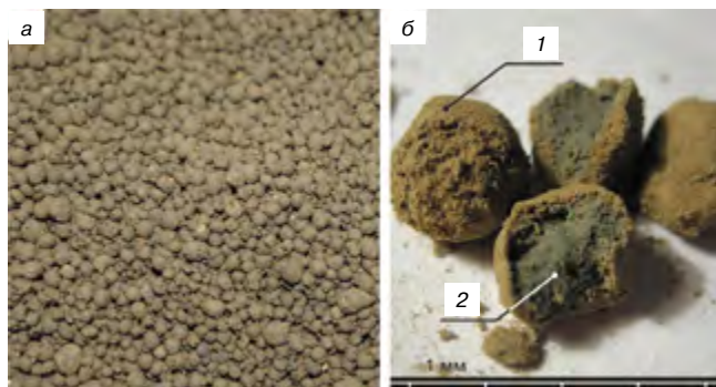
Рис. 1. Внешний вид гранулята из шламистой части отходов обогащения железных руд (а) и структура опудренных гранул на ее основе (б): 1 – опудривающий слой из глины; 2 – гранула из отходов
