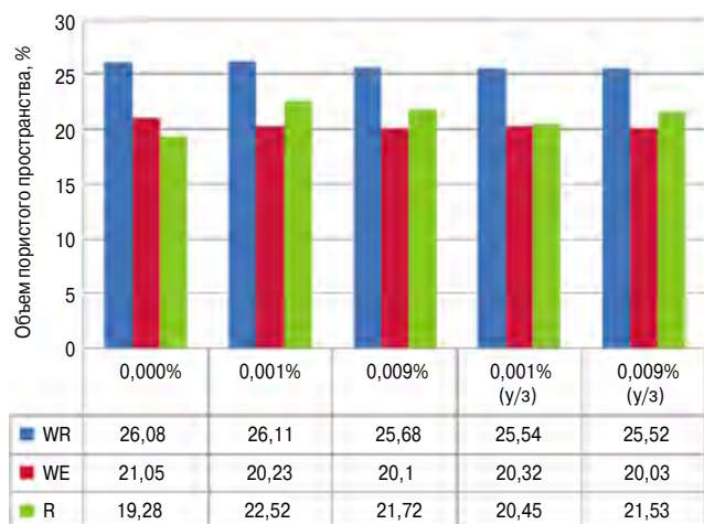
Рис. 8. Объем пористого пространства образцов после обжига: WR – общая открытая пористость; WE – эффективная пористость; R – резерв пористого пространства
