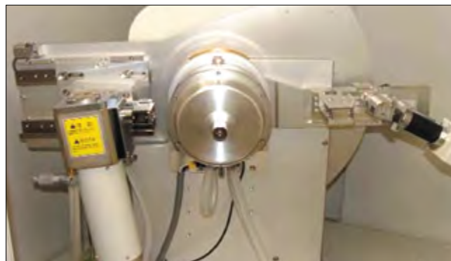
Рис. 4. Дифрактометр XRD-7000S. Общий вид (слева), вид гониометра (справа). Кафедра минералогии и литологии Казанского федерального университета
