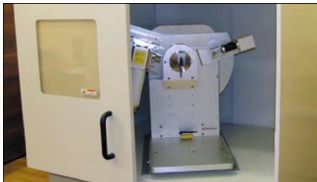
Рис. 4. Дифрактометр XRD-7000S. Общий вид (слева), вид гониометра (справа). Кафедра минералогии и литологии Казанского федерального университета
