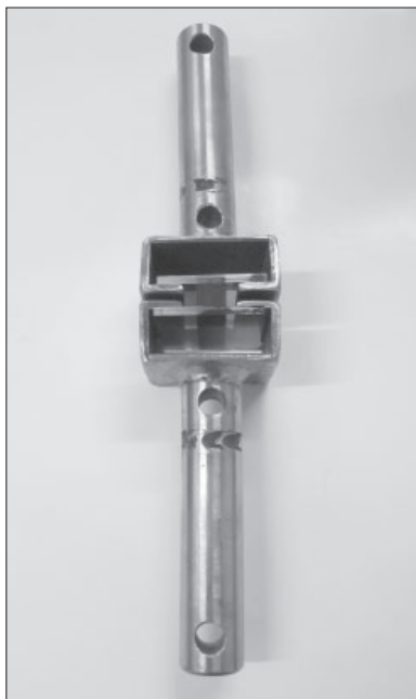
Рис. 5. Внешний вид приспособления к разрывной машине для испытания на растяжение образца-шва герметика
