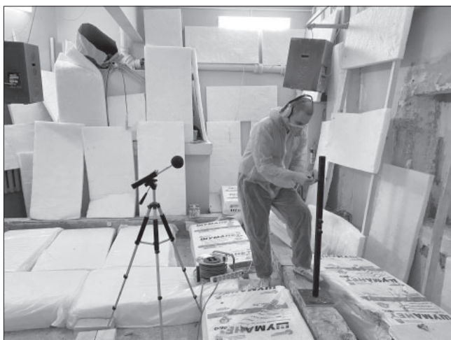
Рис. 2. Фотофиксация эксперимента с шумовой петардой в КВУ Fig. 2. Photofixation of the experiment with a noise firecracker in the high-level chamber
