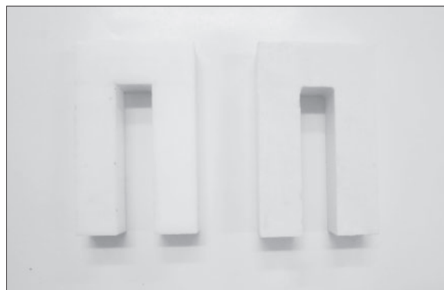
Рис. 1. Фторопластовые формы для изготовления образцов-швов Fig. 1. Fluoroplastic molds for the manufacture of seam samples
