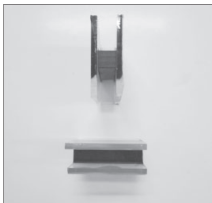
Рис. 2. Образец-шов стекло–стекло для проведения испытаний на растяжение Fig. 2. Specimen-seam glass–glass for tensile testing
