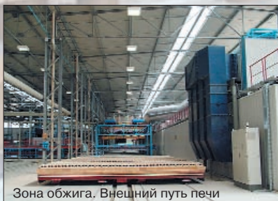
Зона обжига. Внешний путь печи
