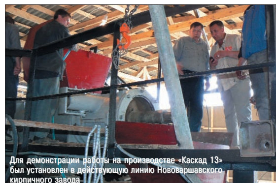
Переработанная на установке «Каскад 13» глина поступает в приемный бункер пресса
