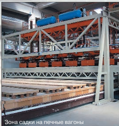
Зона садки на печные вагоны
