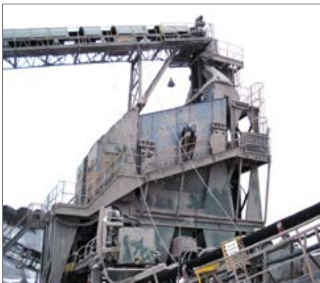
Рис. 3. Общий вид грохота ГИС-54 в составе установки TelSmith (США) на предприятии «Гранит-Кузнечное»
