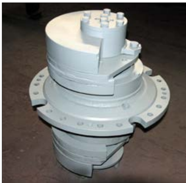
Рис. 1. Виброблок вибровозбудителя инерционного грохота ГИС
