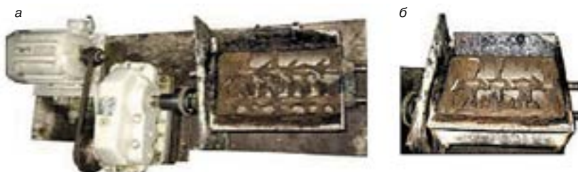
Лабораторная мешалка, моделирующая работу смесителя асфальтобетонного завода: а – общий вид; б – рабочая камера мешалки
