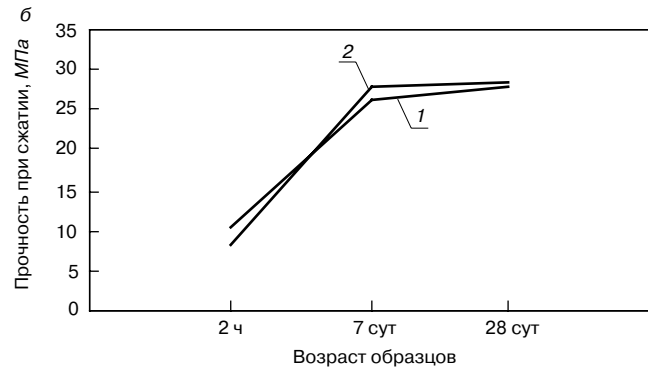
Прочность растворов сухих строительных смесей на основе строительного гипса (1) и фосфополугидрата сульфата кальция (2): а – при изгибе; б – при сжатии
