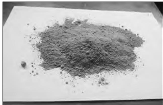
Рис. 1. Базальтовая пыль — отход производства базальтового волокна
