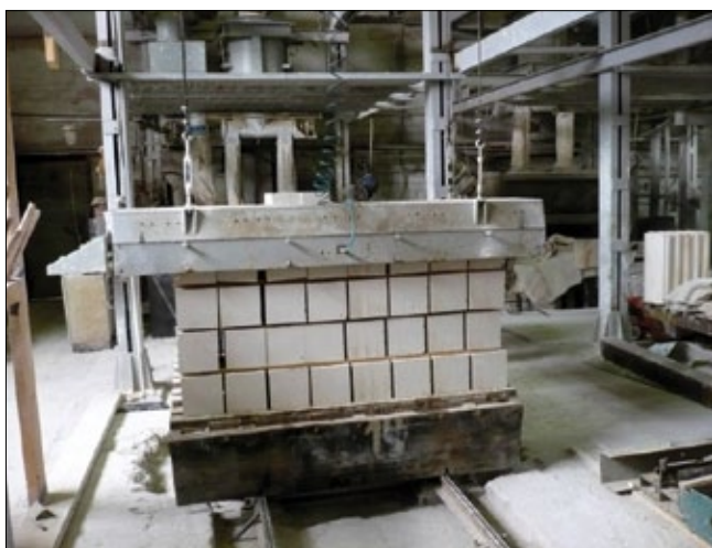
Рис. 1. Производство гипсокерамзитобетонных стеновых блоков на заводе ООО «Уфимская гипсовая компания»
