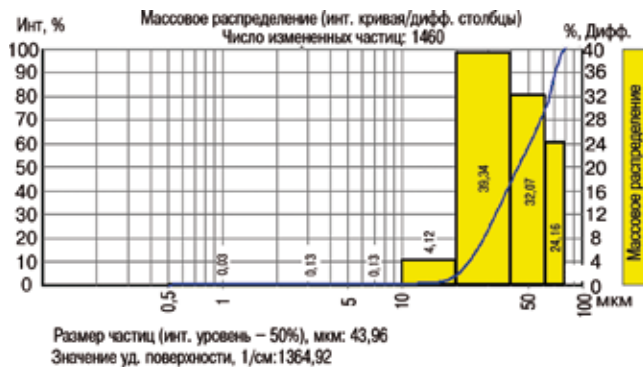
Рис. 3. Гранулометрический состав порошка стекла, полученного из автомобильного стекла
