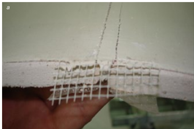
Рис. 4. Характер разрушения стыков при армировании сетчатой лентой (а) и бумажной лентой (б)
