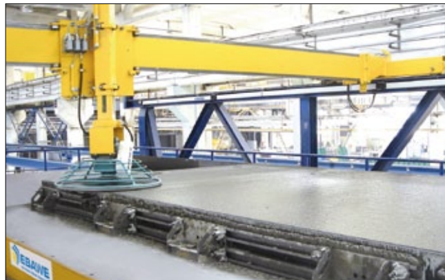
Окончательное заглаживание стеновых элементов при помощи лопастного заглаживателя на заводе UAB «Markuciai» (Вильнюс, Литва)
