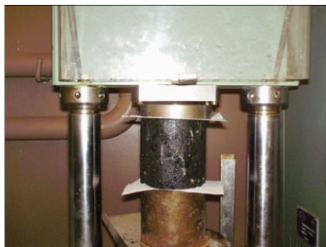
Рис. 2. Процесс испытания асфальтобетонных кернов (образцов)
