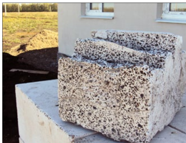
Рис. 2. Структура гипсокерамзитобетона в стеновом блоке
