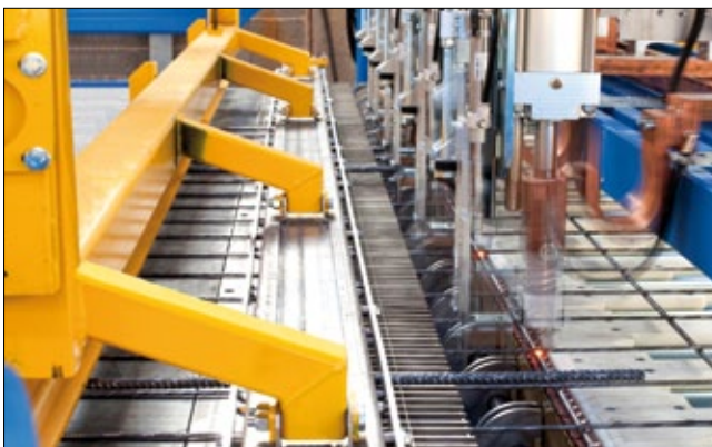
Полностью автоматический аппарат сварки арматурной сетки на заводе по производству готовых элементов группы EBAWE
