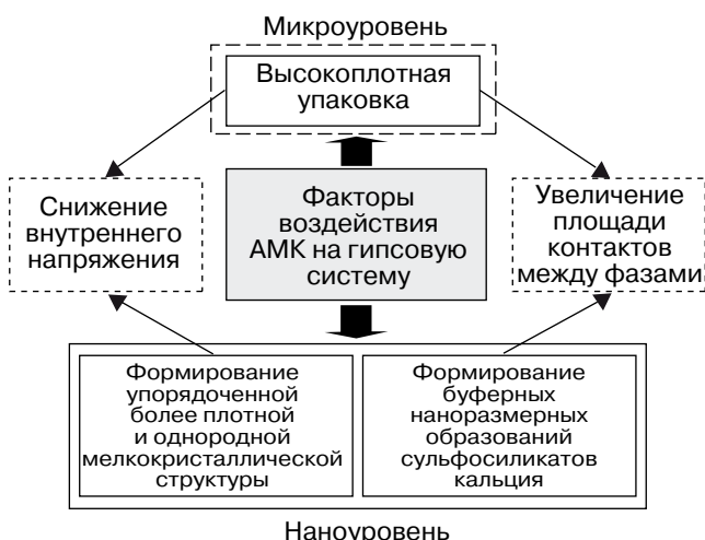
Рис. 1. Механизм формирования композиционного наноструктурированного гипсового вяжущего с применением активного минерального компонента
