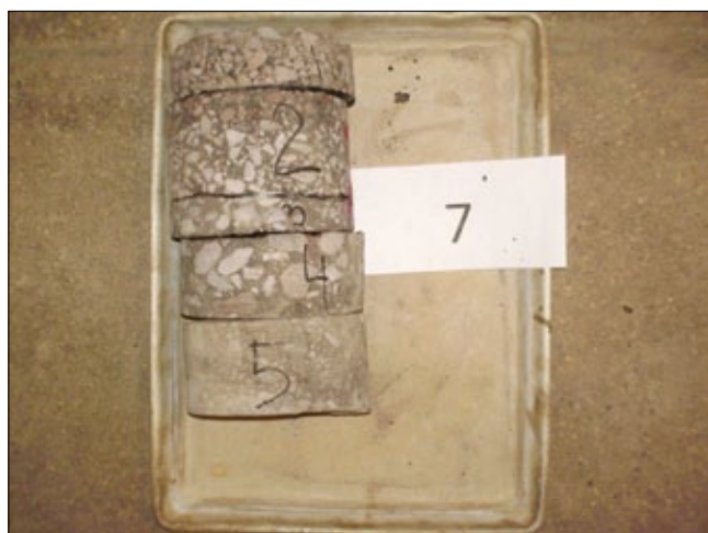
Рис. 1. Керны (образцы), полученные в результате инженерно-геологических изысканий
