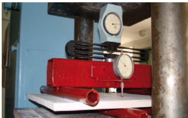
Рис. 3. Приспособление для испытания стыков гипсокартонных образцов
