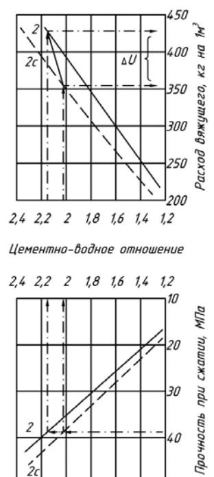
Рис. 4. Номограмма для определения снижения расхода цемента в бетоне марки 400 при введении в бетонную смесь с осадкой конуса 2 см суперпластифицирующей добавки С-3 в количестве 0,5% от массы вяжущего
