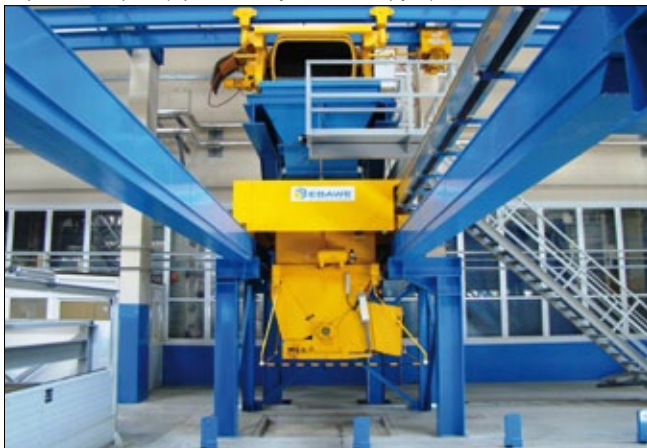
Автоматическое заполнение бетонораздатчика при помощи новой линии автоматической подачи бетона фирмы Kibat
