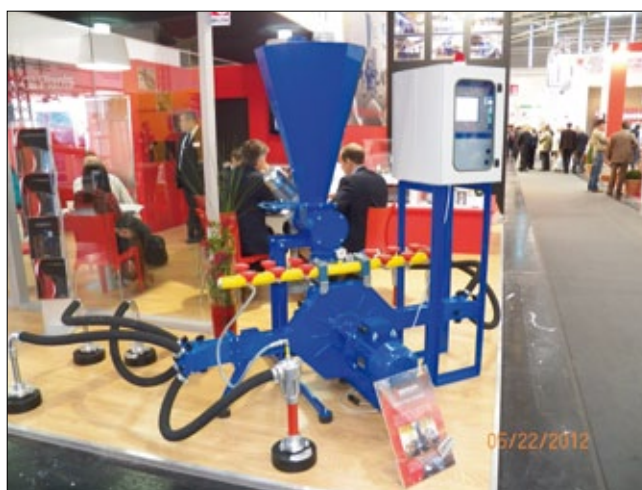
Итальянская компания «Бернини импianti» (BERNINI impianti) представила комбинированную горелочную группу GCS/SFD, которая работает как на газу, так и на твердом топливе. Она может применяться для всех видов печей и позволяет рационально использовать имеющиеся ресурсы, не ухудшая качество кирпича. Горелочная группа GCS/SFD оснащена домалывающим устройством, электронным распределительным щитом и термпарой, центробежным вентилятором
