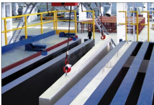
Извлечение готовых бетонных элементов из кассетных форм на ЗАО «ККПД» (Ростов-на-Дону, Россия)
