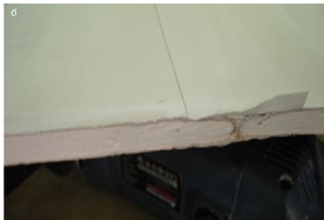
Рис. 4. Характер разрушения стыков при армировании сетчатой лентой (а) и бумажной лентой (б)
