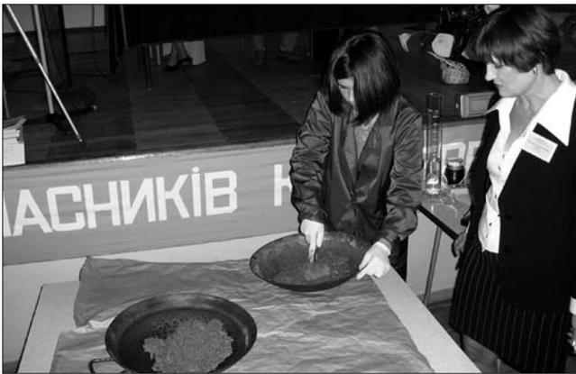
Показательный замес бетона с пластификатором системы «Релаксол» и без него. Введение добавки «Релаксол-СУПЕР» обеспечило хорошие реологические свойства бетонной смеси
