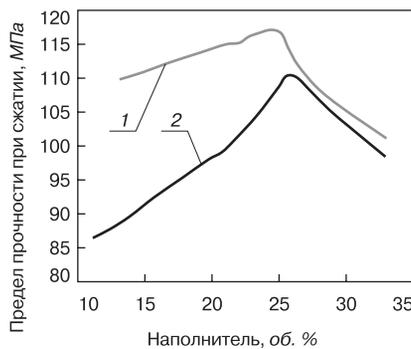
**Рис. 3.** Зависимость предела прочности при сжатии от вида и количества наполнителя: 1 – наполнитель – тонкодисперсные промышленные отходы, кварцевый песок; 2 – наполнитель – тонкодисперсные промышленные отходы, ОСП
