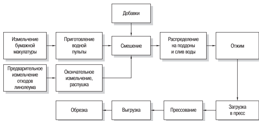
Технологическая схема изготовления листового бумажно-волоконистого материала
