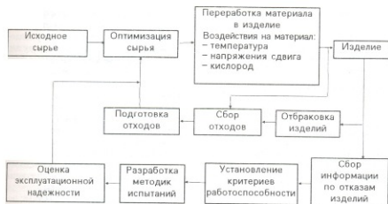
Рис. 2. Модель исследования технологического процесса производства изделий для инженерного обеспечения объектов строительства из конструктивных термопластов и отходов их переработки
