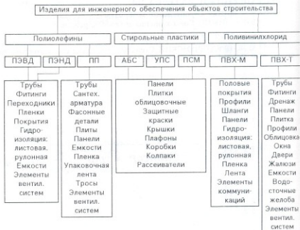
Рис. 1. Классификация изделий для инженерного обеспечения объектов строительства по назначению и маркам материала
