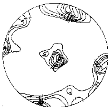
Рис. 3. Диаграмма трещиноватости юго-западного участка месторождения 1—12 — изолинии плотности встречаемости трещин, %
