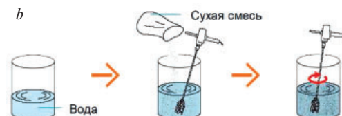
Рис. 4. Приготовление бетонной смеси на монтажном горизонте в автоматизированной растворо-бетонной установке (а) и с использованием механизированного инструмента (б)
