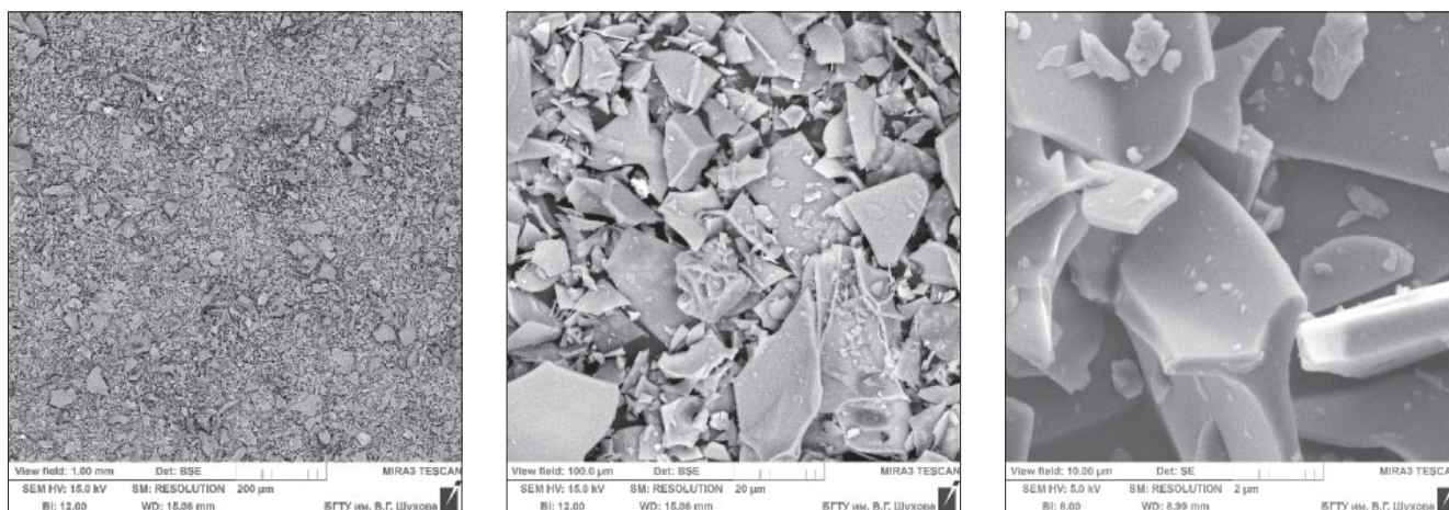
Рис. 3. Микроструктура вспученного перлитового песка, измельченного в течение 3 мин Fig. 3. Microstructure of expanded perlite sand, crushed for 3 minutes
