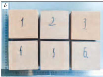
Рис. 3. Фотофиксация образцов после ускоренного климатического старения на 25 УГЭ: a – Gener VX 110; b – Sylomer SR 110 Fig. 3. Photo fixation of samples after accelerated climatic aging at 25 conditional year of operation: a – Gener VX 110; b – Sylomer SR 110
