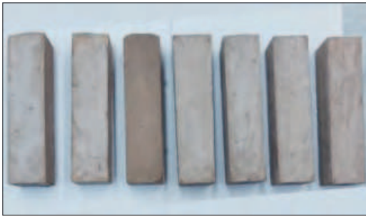
Рис. 3. Образцы мелкозернистого бетона как основы бетонного полотна
