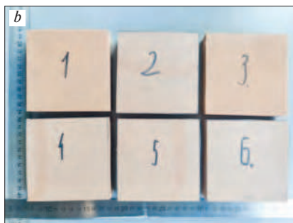
Рис. 1. Образцы для испытаний: а – Gener VX 110; б – Sylomer SR 110 Fig. 1. Samples for testing: a – Gener VX 110; b – Sylomer SR 110
