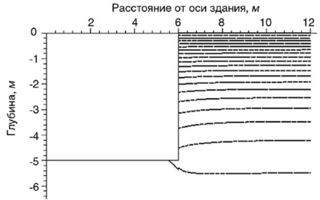
Рис. 6. Характер распределение изолиний концентрации радона в грунте при заглублении здания, равном 5 м
