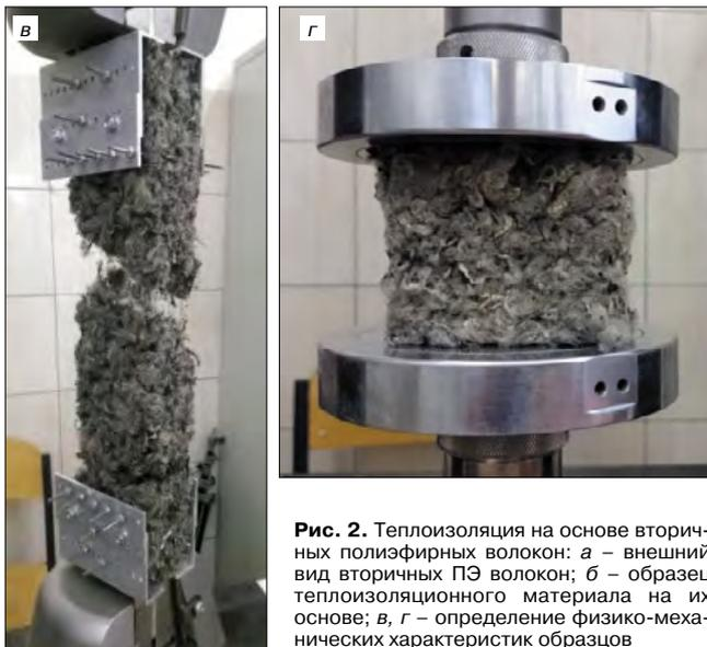
Рис. 2. Теплоизоляция на основе вторичных полиэфирных волокон: а – внешний вид вторичных ПЭ волокон; б – образец теплоизоляционного материала на их основе; в, г – определение физико-механических характеристик образцов
