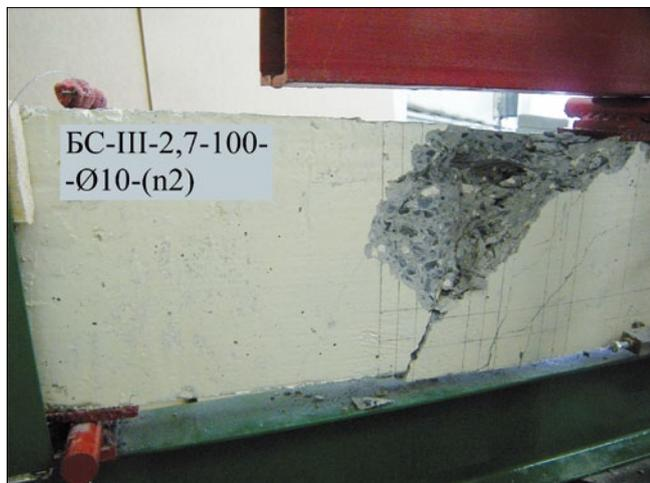
Рис. 7. Характер разрушения опытной конструкции третьей серии БС-III-2,7-100-Ø10-(n2)
