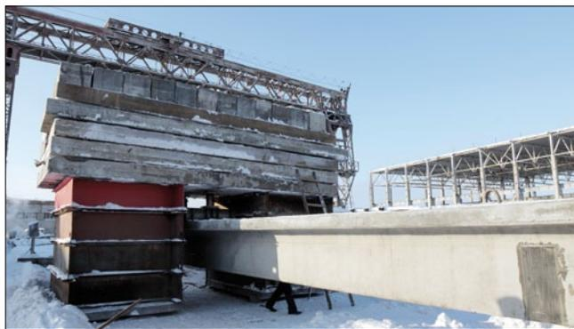
ность использования СВА углеродными лентами и углепластиковыми ламелями (новый продукт холдинговой компании «Композит») на конструкциях в натуральную величину: неусиленных балках; балках, усиленных углеродными лентами и хомутами; балках, усиленных углеродными ламелями и хомутами.
