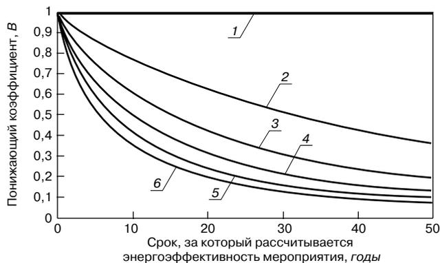
Рис. 3. Зависимость понижающего коэффициента от времени. Процентная ставка банка, р.: 1 – 0; 2 – 0,05; 3 – 0,1; 4 – 0,15; 5 – 0,2; 6 – 0,25
