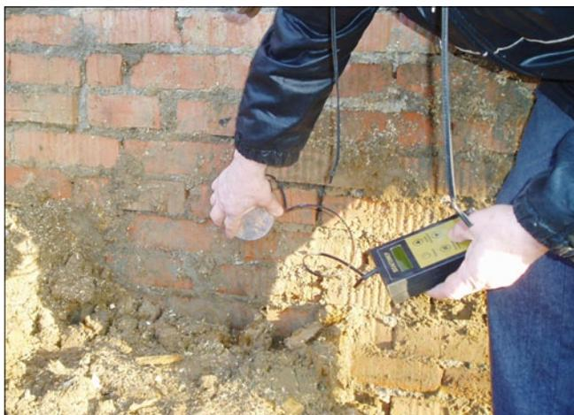
Рис. 1. Измерение влажности и теплопроводности в стене из сплошного кирпича
