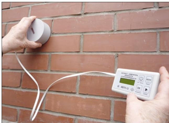
Рис. 2. Измерение влажности и теплопроводности в стене из поризованного пустотного кирпича
