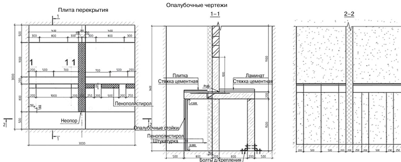
Рис. 3. Схема экспериментальной конструкции, установленной в климатической камере НИИСФ РААСН
