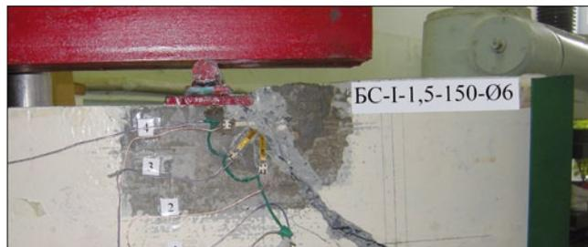
Рис. 8. Срез с раздавливанием опытной конструкции первой серии БС-I-1,5-150-Ø6
