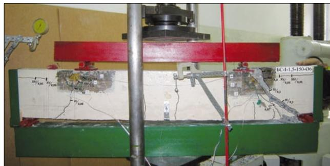
Рис. 9. Появление трещин вдоль шва между бетонами на XIV ступени в опытной конструкции первой серии БС-I-1,5-150-Ø6
