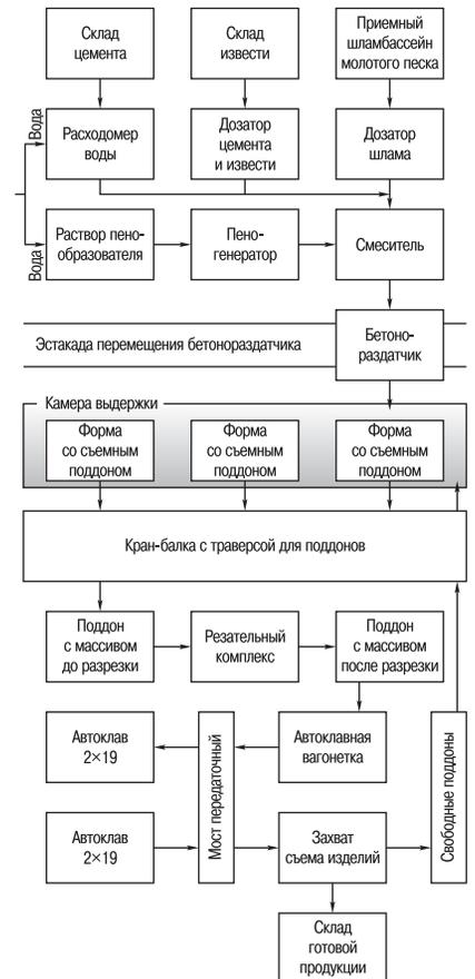
Рис. 1. Принципиальная схема линии по производству изделий из автоклавного пенобетона по резательной технологии
