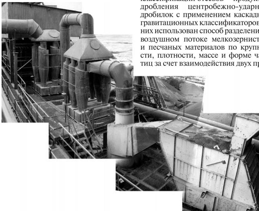
Рис. 1. Комплекс классификации отсевов дробления производительностью 30 т/ч на руднике Малый Куйбас (г. Магнитогорск)
