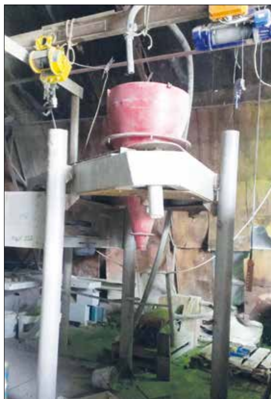
Рис. 3. Рабочая камера ВРК капсулятора-смесителя для установки по производству капсулированного крупного заполнителя производительностью 10 м 3 /ч
