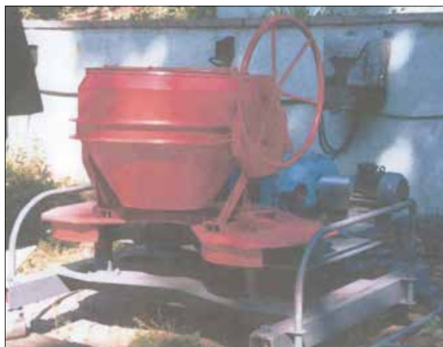
Рис. 4. Мобильный капсулятор-смеситель КЦ-2 для ремонтных работ по крупнопористому дренажному бетону КАПСИМЭТ на трассах Fig. 4. Mobile capsulator-mixer KT-2 for repair work on large-pore draining concrete CAPSIMET on highways
