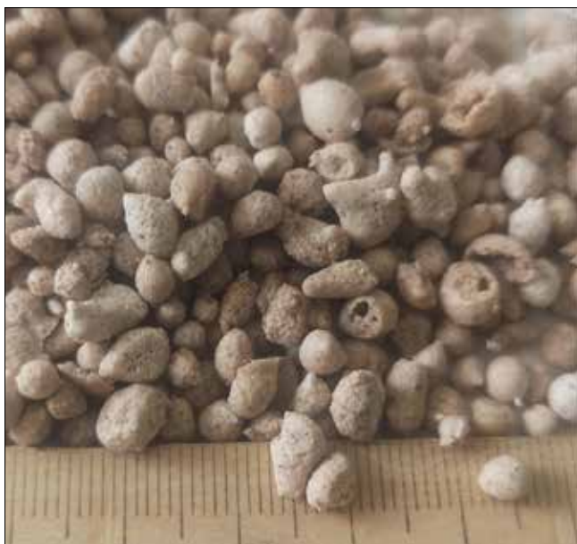
Рис. 3. Искусственный пористый мелкий заполнитель и его структура Fig. 3. Artificial porous fine aggregate and its structure
