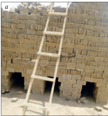
Рис. 1. Кирпичи, выложенные для обжига (а) и обожженные, готовые к использованию (б)
