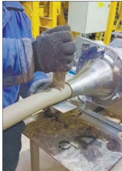
Рис. 8. Экструзия керамической трубы Fig. 8. Ceramic pipe extrusion
