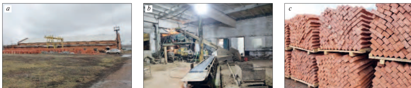
Рис. 5. Бузулукский кирпичный завод: а – производственный корпус завода; б – технологическая линия прессования и резки кирпича; с – готовая продукция Fig. 5. Buzuluk brick factory: a – the production building of the plant; b – the technological line of pressing and cutting bricks; c – finished products
