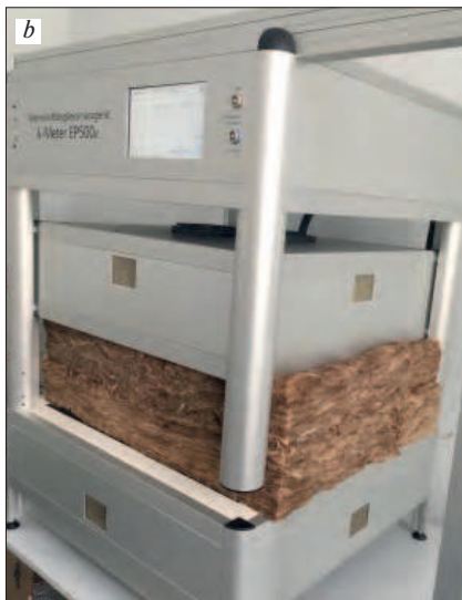
Рис. 1. Испытания теплопроводности образцов керамических крупноформатных камней на приборе Lambda-Meter EP500e Fig. 1. Thermal conductivity tests of ceramic large-format clay blocks on the Lambda-Meter EP500e device
