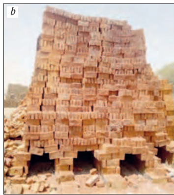
Рис. 1. Кирпичи, выложенные для обжига (а) и обожженные, готовые к использованию (б)
