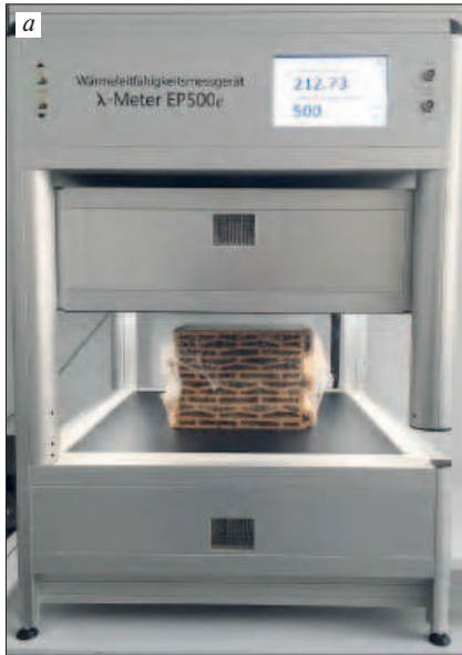
Марка № 1 Керамический крупноформатный камень с пустотами в виде параллелограмма и отверстиями для захвата пальцами
