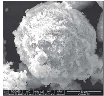
Рис. 4. Микрофотография частиц аспирационной пыли при увеличении ×2000
