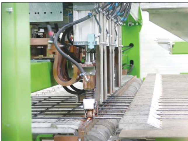
Установка для сварки арматурной сетки BlueMesh® фирмы Progress Maschinen & Automation выпускает требуемые арматурные сетки «точно в срок» и с минимальными затратами. Автоматическая гибочная установка служит для торцевого загиба выступающих частей прутьев Reinforcement mesh welding plant BlueMesh® of Progress Maschinen & Auto Progress Maschinen & Automation's BlueMesh® produces the required reinforcement meshes «just in time» and at minimal cost. The automatic bending machine is used for the end bend of the protruding parts of the bars
