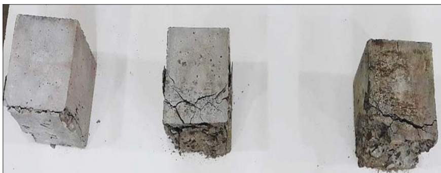
Рис. 3. Образцы бетонов нормального твердения после выдержки их в среде нефтепродуктов (7, 28 и 180 сут)
