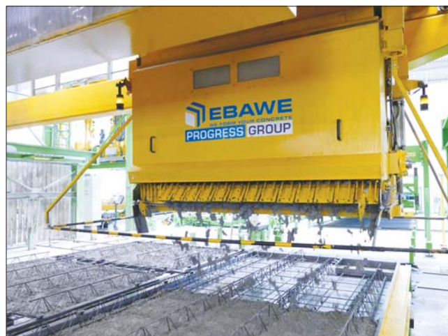
Благодаря новому заводу ЖБИ в Гданьске компания Pekabex смогла расширить ассортимент своей продукции из филигранных/сборных перекрытий и типовых стеновых панелей двойными стеновыми панелями с теплоизоляцией и без
