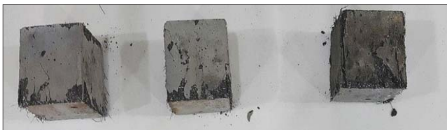
Рис. 2. Образцы порошково-активированных бетонов после выдержки их в среде нефтепродуктов (7, 28 и 180 сут)
