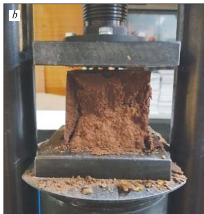
Рис. 6. Опалубка из формопласта для изготовления образцов-кубов размерами 7×7×7 см (а) и разрушенный образец (b)
