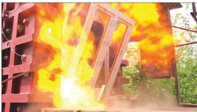
Рис. 2. Испытание ЛСК со стеклопакетом на воздействие внутреннего взрыва газа
