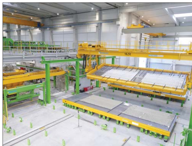
Вид на новый производственный цех компании Pekabex в Гданьске с бетонораздатчиком, автоматическим переворачивающим устройством и арматурным участком на втором уровне
