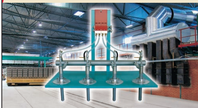
Установка по сжиганию твердого топлива
