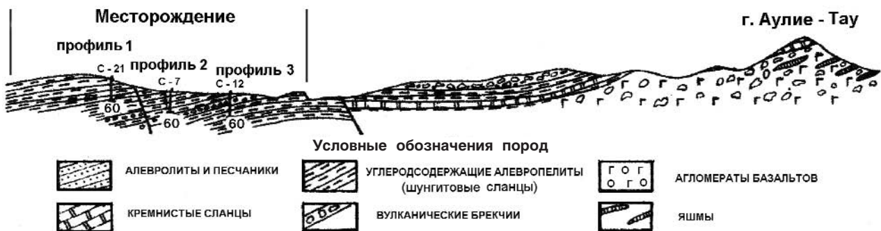
Рис. 1. Схематический продольный геологический разрез по северной части Аулиинской синклинали
