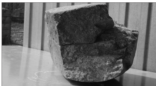
Рис. 3. Валун после двухминутного пребывания в дробилке
