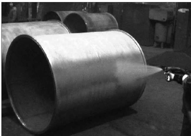
Рис. 1. Напыление на магнитный сепаратор на ОАО «Рудгормаш»
