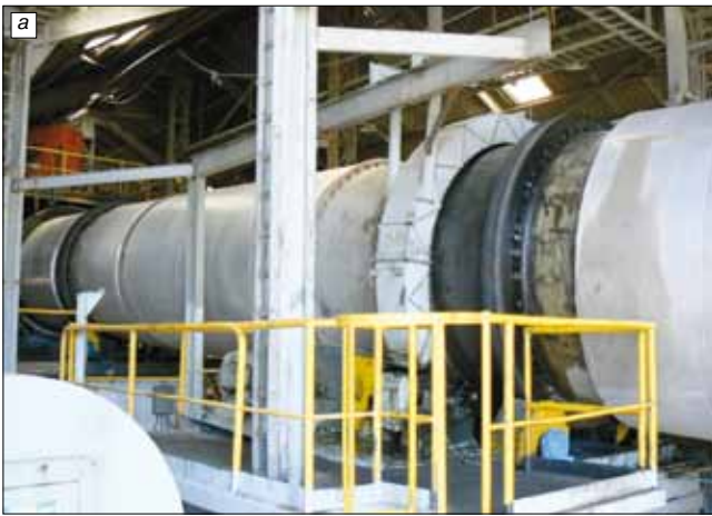
Рис. 2. Для сушки руды на предприятии применяется два типа сушилок: барабанные (а) и кипящего слоя (б). Общая производительность 5 печей 60 т/ч
