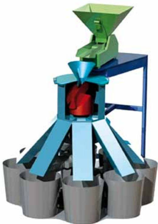
Рис. 1. Делитель проб ротационный центробежный в комплекте с электровибрационным питателем и приемными устройствами
