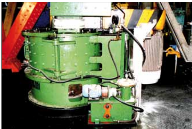
Рис. 3. Основным дробильным аппаратом является вертикальная молотковая дробилка, производительностью 70 т/ч. Дробилки имеют хорошую избирательность дробления и высокую степень вскрытия хризотилового волокна
