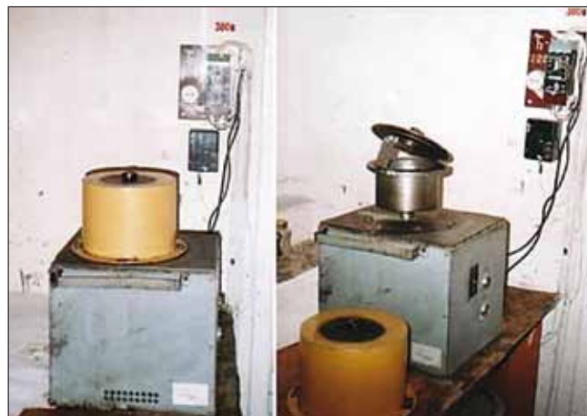
Лабораторный центробежно-лопаточный смеситель-диспергатор (ЦЛС) Рыбинского авиационного университета с частотой вращения рабочей емкости 950 об/мин.
