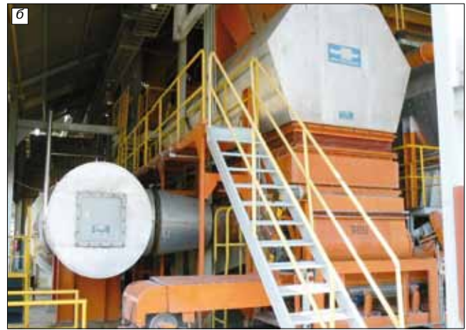
Рис. 2. Для сушки руды на предприятии применяется два типа сушилок: барабанные (а) и кипящего слоя (б). Общая производительность 5 печей 60 т/ч
