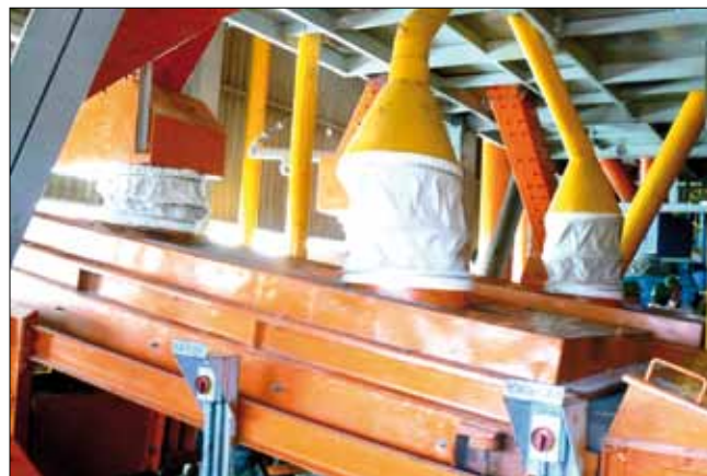
Рис. 4. Классификация производится на грохотах с отсасыванием хризотилового концентрата из продуктов верхних сит грохота и барабанов
