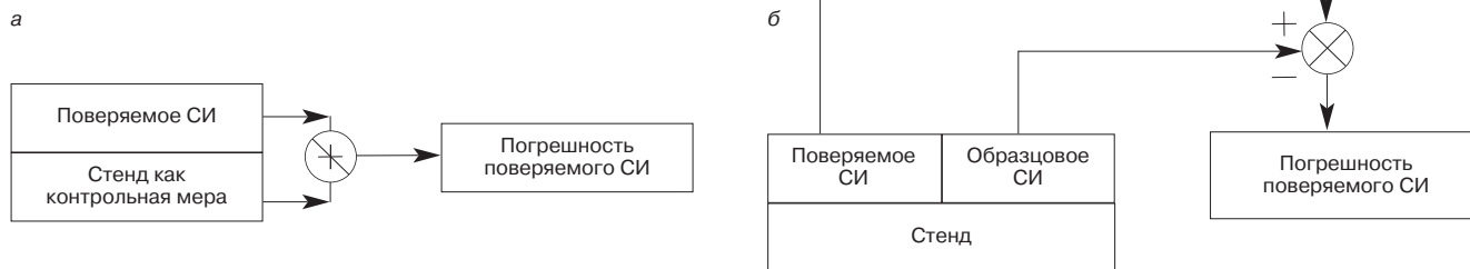
Определение погрешности: а – процедура поверки по образцовой мере; б – поверка по образцовому прибору
