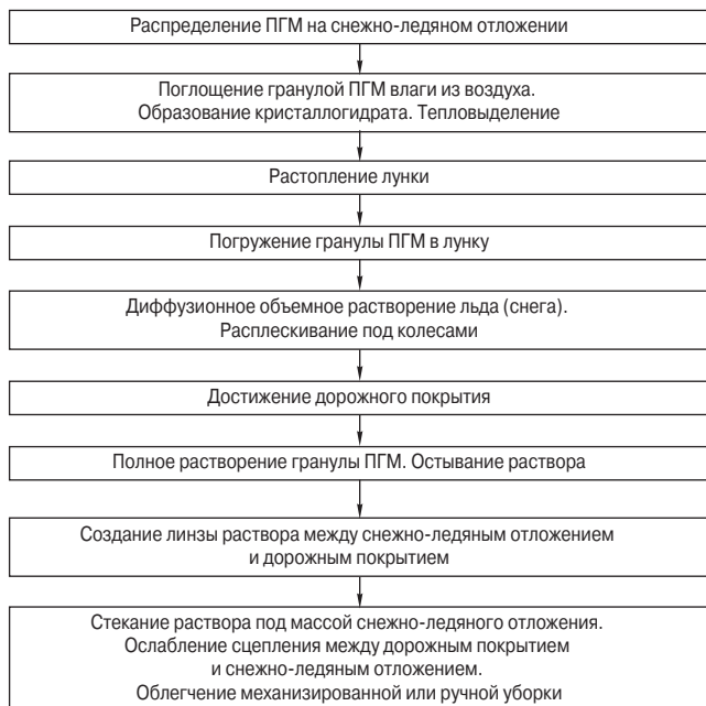
Рис. 6. Фазовые состояния механизма «теплого сверла» – взаимодействия тепловыделяющего ПГМ со снежно-ледяным отложением
