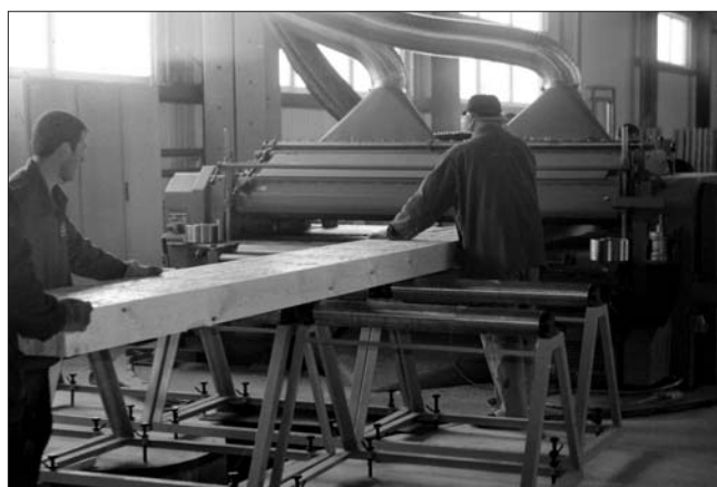
Чистовая прострожка готовой клееной конструкционной балки
