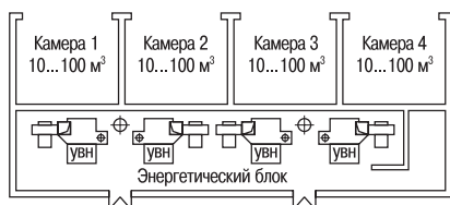
Рис. 1. Схема многокамерного СК
