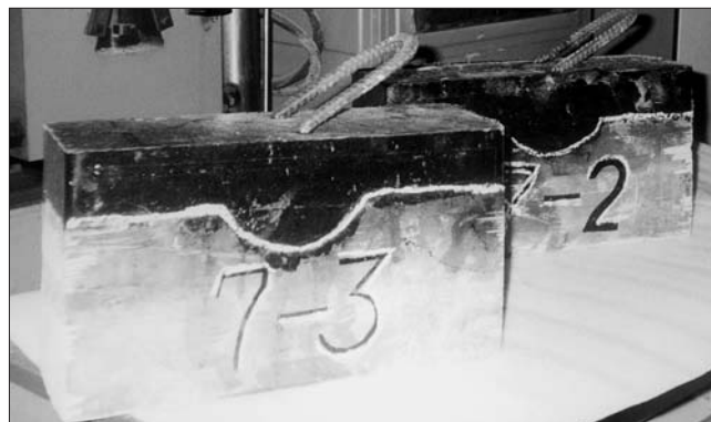
Рис. 2. Механические испытания фрагмента дерево-полимерной балки с арматурными выпусками в лаборатории Воронежского ГАСУ
