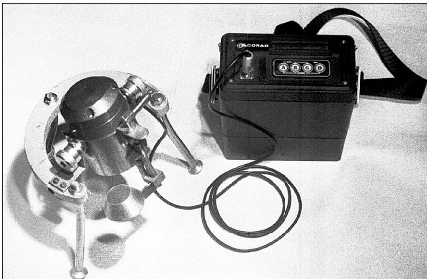
Рис. 2. Внешний вид прибора для измерения удельной активности строительных материалов
