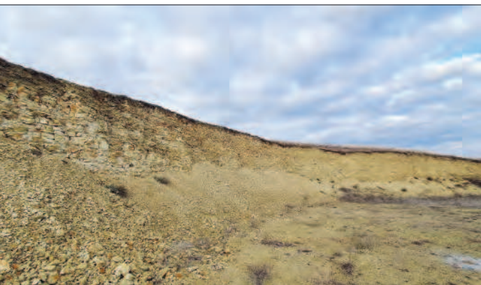
Рис. 1. Уступ карьера классических опоковидных пород. Кусочки породы не разрушаются несколько лет при многократных циклах замораживания и оттаивания
