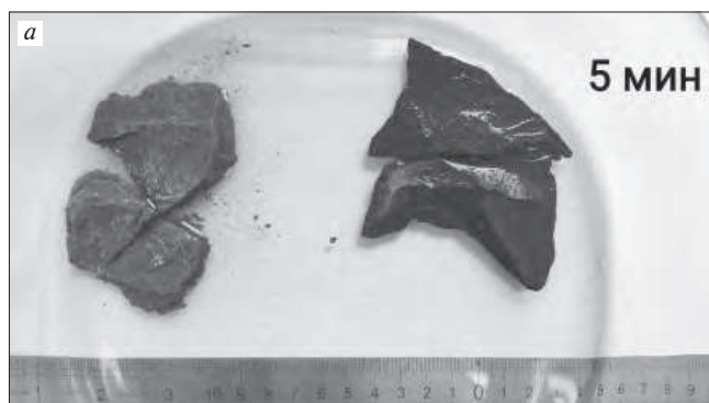
Рис. 5. Кусочки аргиллитоподобной глины и глинистого сланца после 5 мин (а) и 24 ч (б) замачивания в воде Fig. 5. Pieces of argillite-like clay and clay slates after 5 minutes (a) and 24 hours (b) soaking in water
