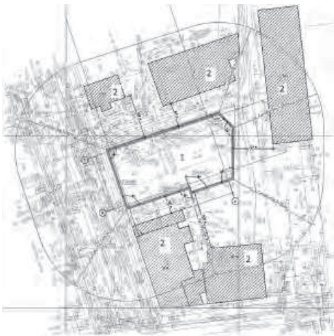
Рис. 1. Границы зоны геотехнического влияния Fig. 1. Boundaries of the geotechnical influence zone
