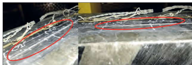
Рис. 12. Разрушение образца с отслоением углепластика
