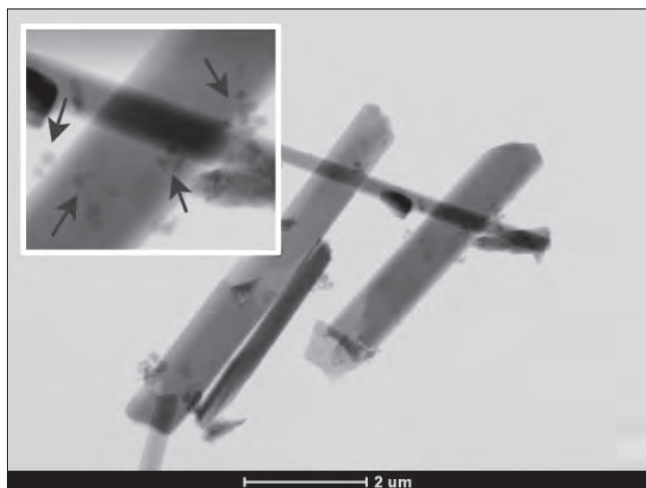
Рис. 5. ПЭМ изображения образца гипсового модифицированного камня
