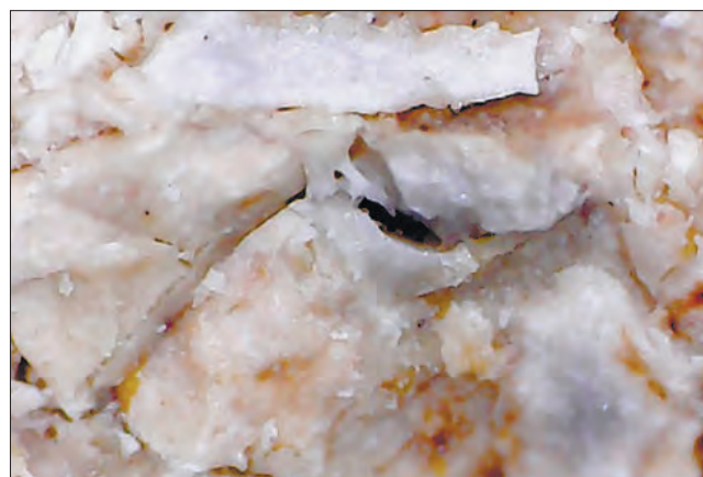
Рис. 4. Микроструктура цементного камня на основе алюмокальциевого вяжущего с добавкой тонкомолотого высокоглиноземистого шамота (микрофото М.Н. Барановой)
