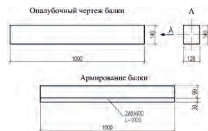
Рис. 3. Опалубочный чертеж и армирование балки
