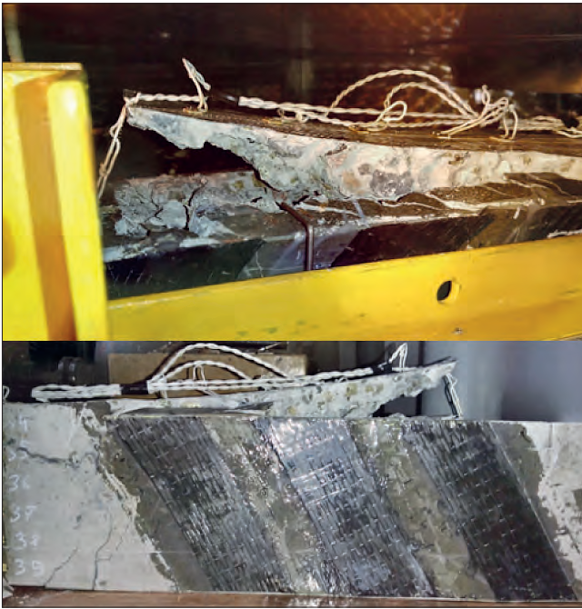
Рис. 6. Разрушение балки Fig. 6. Destruction of the beam
