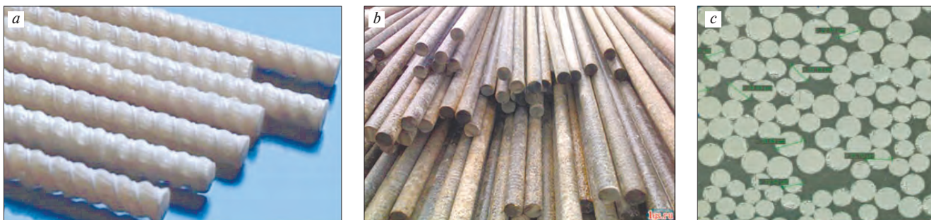
Рис. 2. Образцы ПКР, представленные на рынке РФ: а – с вдавленным профилем; б – песчаный профиль; с – микрофотография фрагмента поперечного сечения ПКР (×300)
