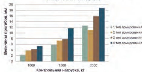
Гистограмма изменения прогибов в балках разного типа армирования при контрольных нагрузках
