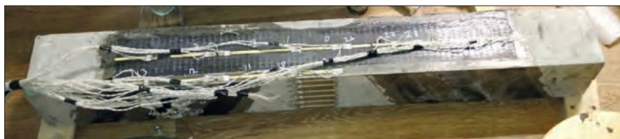
Рис. 5. Схема расположения тензодатчиков (ТД-20 – тензодатчик с базой 20 мм; ТД-50 – тензодатчик с базой 50 мм)
