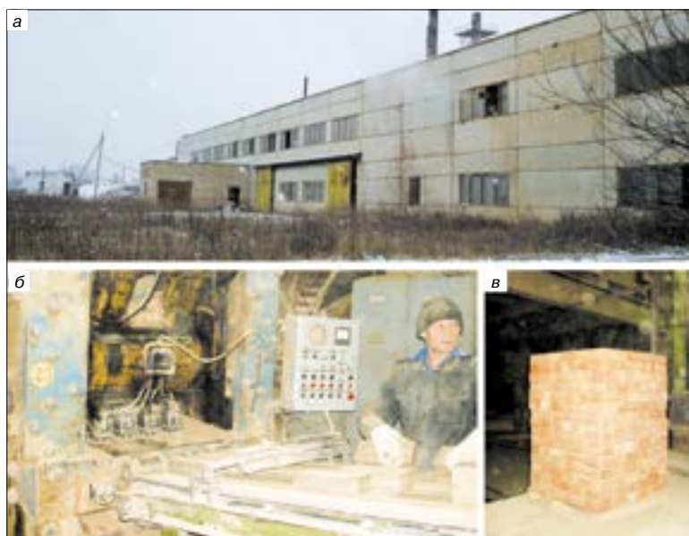
Рис. 3. Выпуск опытной партии керамического кирпича из углистых аргиллитов на заводе «Красный кирпич» (Шарыпово, Красноярский край): а – производственный корпус завода; б – прессование сырца на прессе СМ-1085Б; в – кирпич после обжига
