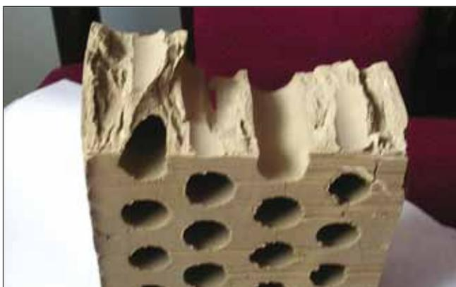
Рис. 1. Структура кирпича-сырца до внедрения мероприятий по ликвидации проворачивания массы
