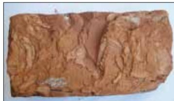
Рис. 4. Кирпич П.БЪЛЯЕВА, разрушившийся после 15 циклов замораживания-оттаивания
