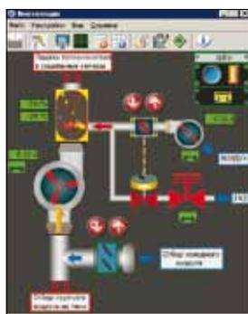
Модуль вентиляции. Графическое отображение программного модуля.
