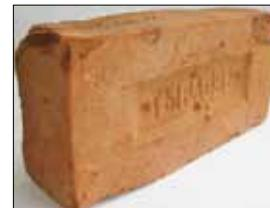
Рис. 5. Образец № 1 кирпич ТЫРЛОВЪ после 60 циклов испытаний на морозостойкость
