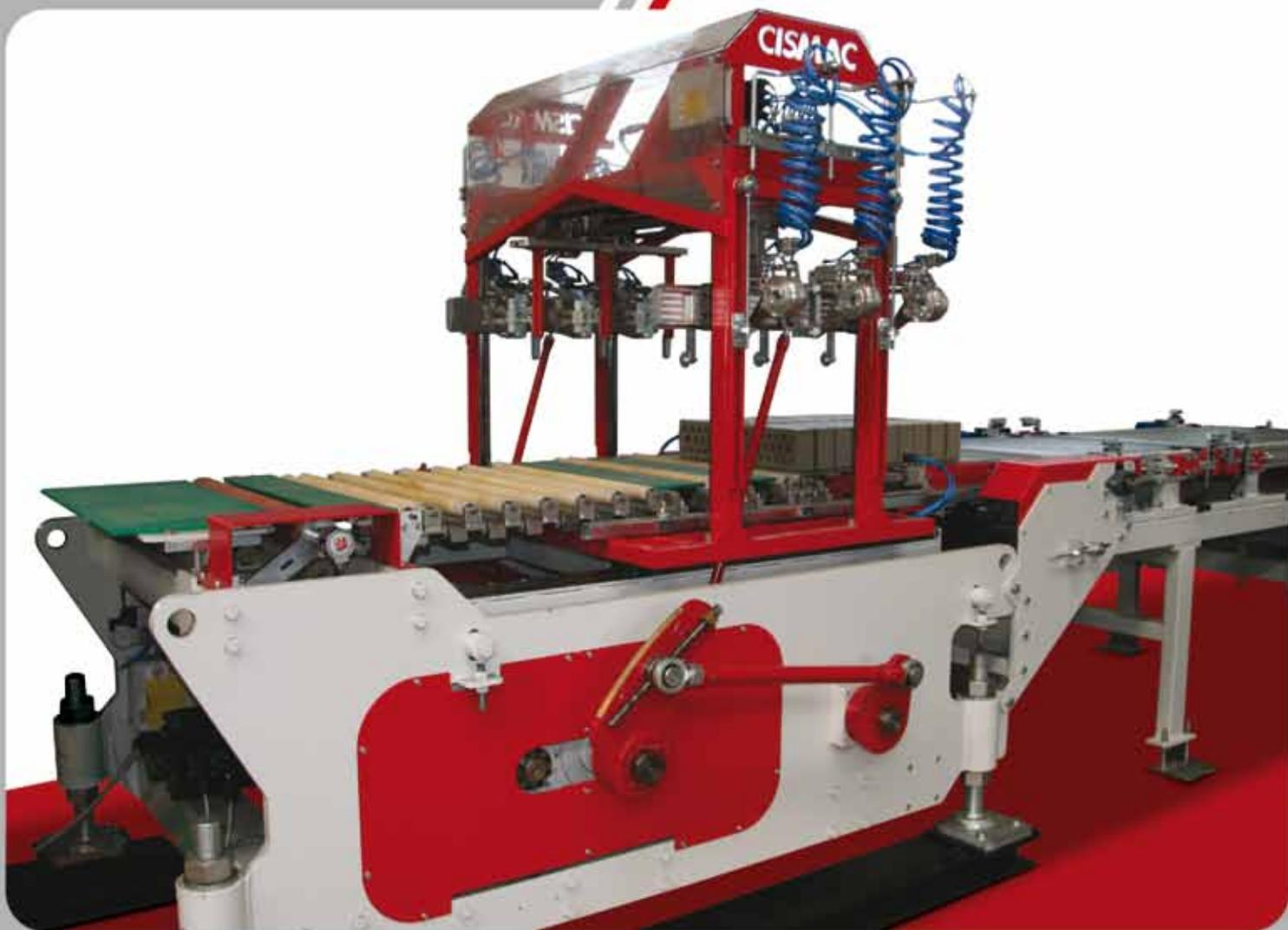
Система резки, позволяющая производство всей гаммы продукции. Возможна как однострунная, так и многострунная резка со снятием кромки.
