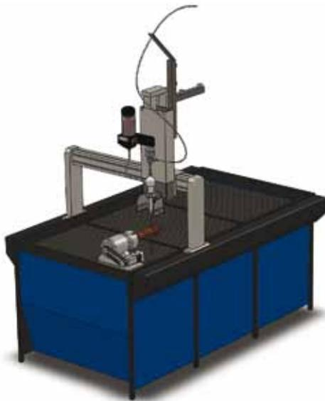
Рис. 2. Общий вид установки ГАР с поворотной головкой
