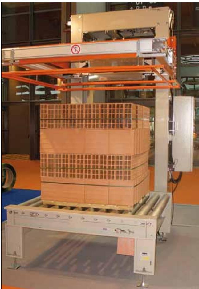
Автоматическая машина для горизонтальной обвязки
