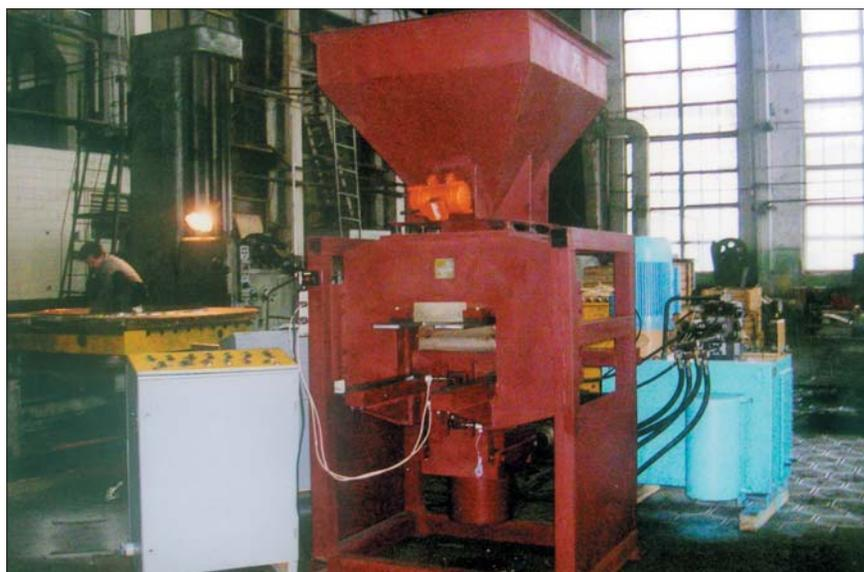
Рис. 1. Установка формования кирпича «Стройпрогресс ЛТД» (пресс, гидростанция, пульт)
