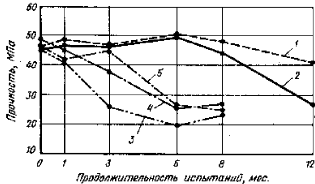
Рис. 1. Изменение прочности образцов асбестоцемента в период их выдерживания во льду: 1 — питьевой воды; 2 — 5 %-ного раствора NaCl ; 3 — то же, K_2CO_3 ; 4 — то же, CaCl_2 ; 5 — то же, KOH
