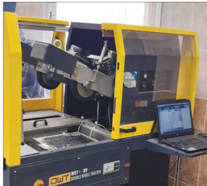
Рис. 7. Испытания на колеобразование (машина DWT 78-PV33B05) Fig. 7. Rutting tests on DWT 78-PV33B05
