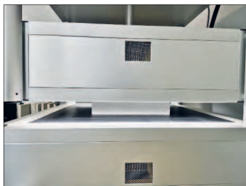
Рис. 1. Испытания теплопроводности образцов АЯБ на приборе Lambda-Meter EP500e Fig. 1. Thermal conductivity tests of aerated concrete samples on the Lambda-Meter EP500e device
