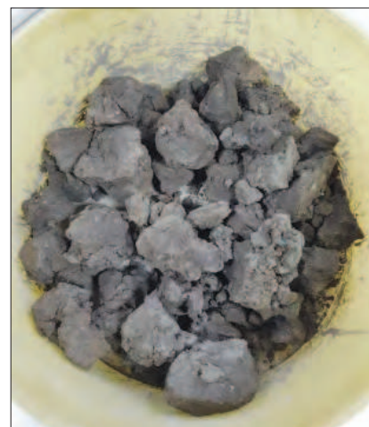
Рис. 5. МПСП после обжига в муфельной печи при температуре 950°C Fig. 5. Mineral product of soda production sample after firing in a muffle furnace at a temperature of 950°C
