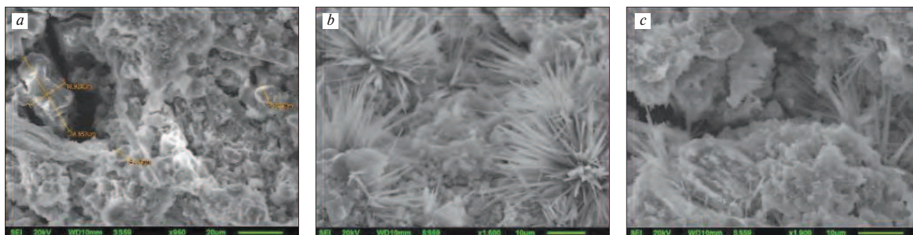
Рис. 3. Поверхность образца МПСП при увеличении: а – 950×; б – 1600×; в – 1900×
