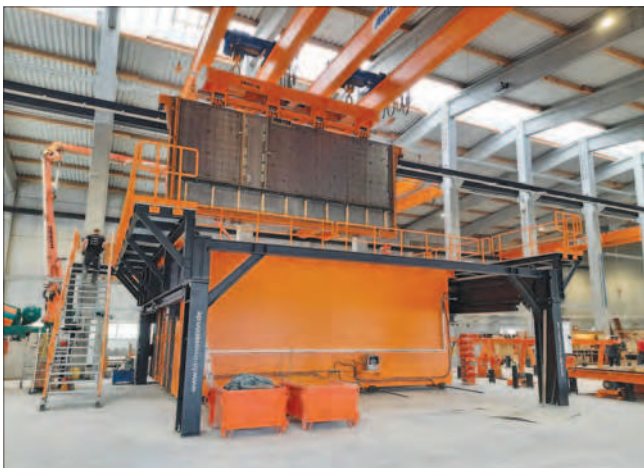
Установка опалубки «Бабочка» в кассетную установку Installation of the "Butterfly" formwork in a cassette unit
