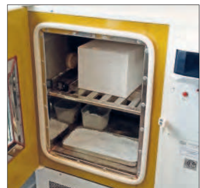
Рис. 2. Кондиционирование образцов АЯБ в камере с влагопоглотителем Fig. 2. Conditioning of autoclaved aerated concrete samples in a chamber with a desiccant
