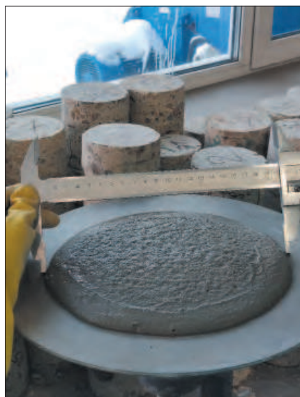
Рис. 1. Замеры расплыва конуса цементно-песчаной смеси состава № 4 ( R_k=210 мм)
