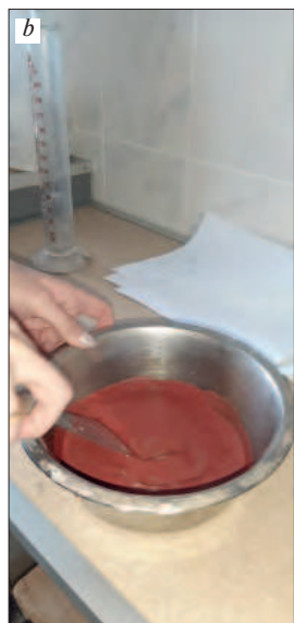
Рис. 8. Процессы приготовления и нанесения готового состава: a – гомогенизация сухой смеси в дисковом истирателе; b – перемешивание сухой смеси с водой; c – нанесение с помощью краскопульта
