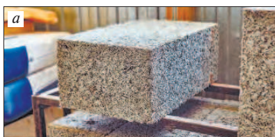
Рис. 2. Внешний вид изделий из бетона с добавками органического происхождения (лен, конопля): а – блок 600×200×300 мм ( https://images.ua.prom.st/2068300558_w640_h640_arbolit-stroitelnye-bloki.jpg ); б – варианты изделий ( https://static.tildacdn.com/tild6361-3833-4261-b930-313532333431/arbolit-armoblok-8.jpg )
