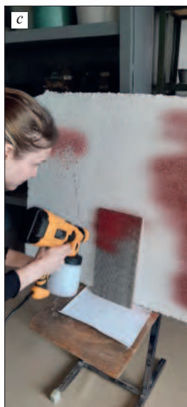
Рис. 8. Процессы приготовления и нанесения готового состава: a – гомогенизация сухой смеси в дисковом истирателе; b – перемешивание сухой смеси с водой; c – нанесение с помощью краскопульта
