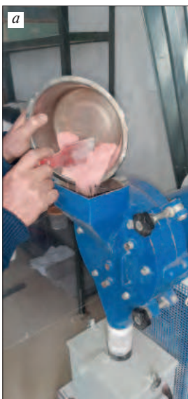
Рис. 8. Процессы приготовления и нанесения готового состава: a – гомогенизация сухой смеси в дисковом истирателе; b – перемешивание сухой смеси с водой; c – нанесение с помощью краскопульта
