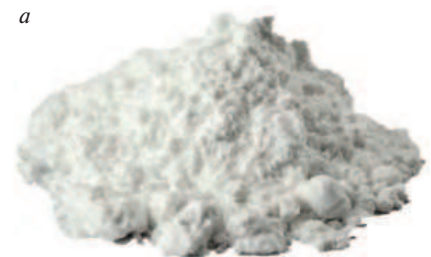
Рис. 6. Компоненты сухой смеси для приготовления фасадной краски: a – нанодиоксид титана; b – щелочестойкий пигмент; c – фосфат натрия; d – растворимое натриевое стекло; e – белый портландцемент
