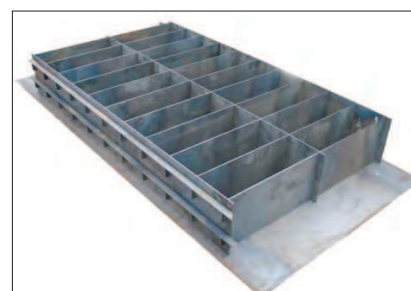
Рис. 4. Внешний вид формы для изготовления бетонных блоков 600×200×300 мм
