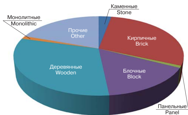
Рис. 1. Применение строительных материалов для несущих конструкций малоэтажного жилого строительства
