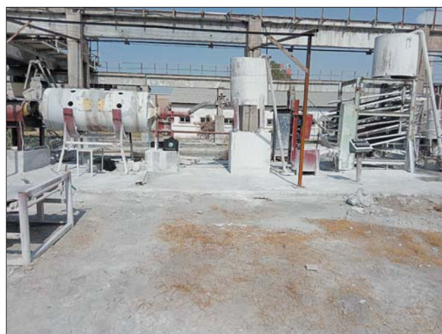
Рис. 3. Общий вид установки регенерации хризотил-асбеста Fig. 3. General view of chrysotile asbestos regeneration unit
