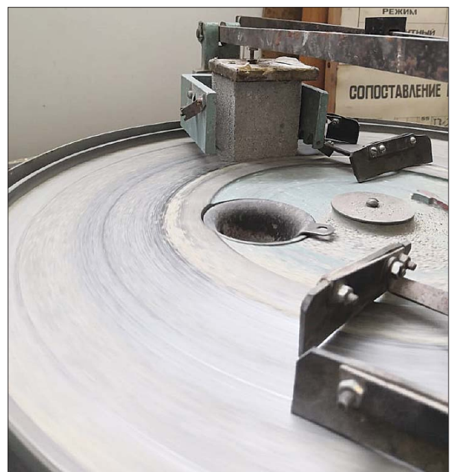
Рис. 6. Исследование истираемости Fig. 6. Studies of abrasion
