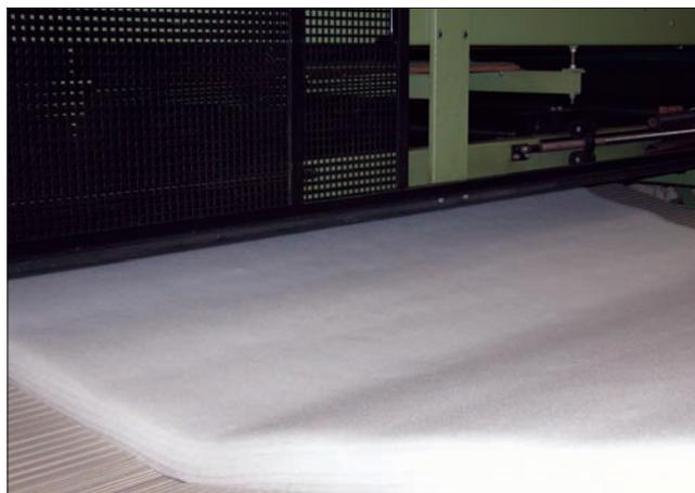
**Рис. 1.** Теплоизоляционный материал КипТек с горизонтально направленными волокнами
