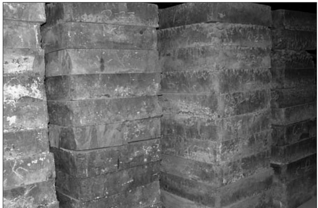
Рис. 3. Пеностеклянные плиты
