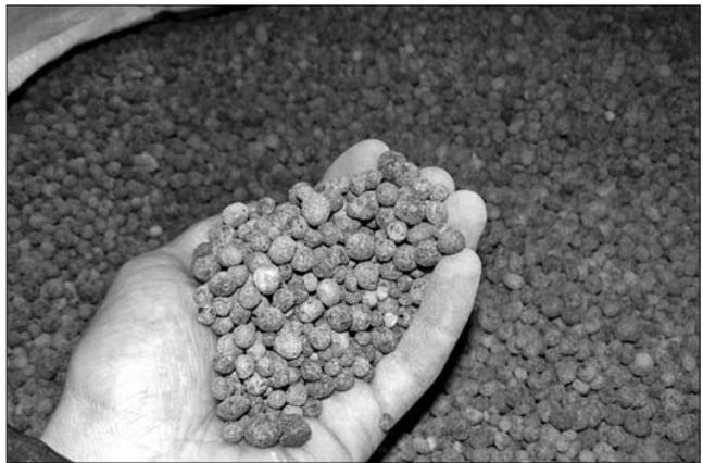
Рис. 2. Внешний вид пеностеклянного гравия
