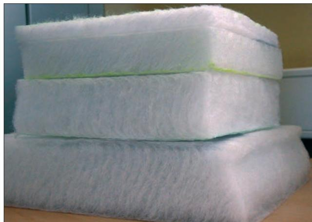
**Рис. 2.** КипТек с вертикальным расположением волокон отличается как по плотности, так и по толщине
