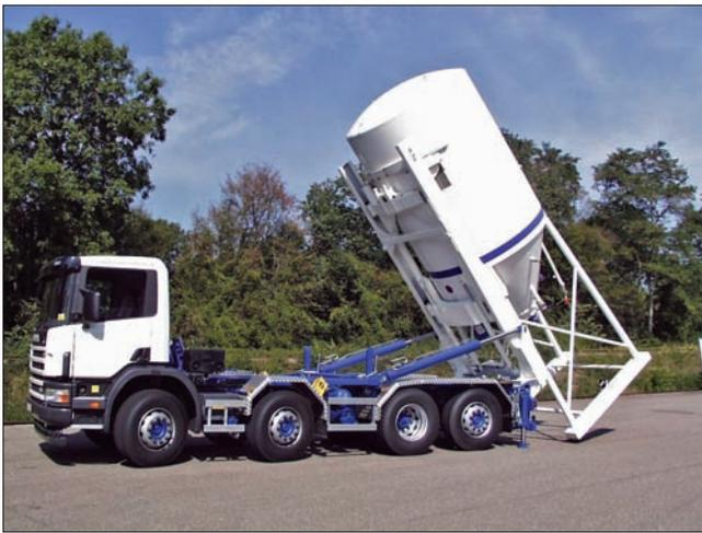
Рис. 2. Силос для транспортирования ССС с помощью специальных карманов разгружается на строительной площадке за 1–2 мин
