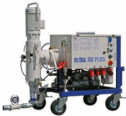
Рис. 3. Современная штукатурная машина DUO-MIX PLUS может готовить раствор из смесей, упакованных в мешки или доставленных на стройку в силосах
