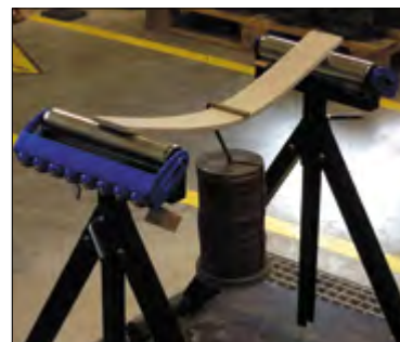
Рис. 2. Демонстрация возможностей текстиль-бетона при приложении изгибающей нагрузки
