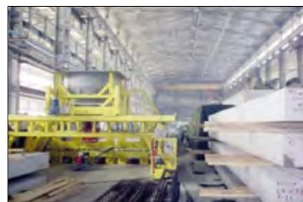
Рис. 1. Ввод в эксплуатацию после технического перевооружения универсального станда и формовочных столов 4×12 м с кантованием для выпуска конструкций сборно-монолитного каркаса с «НС» нового типа в ООО «Маскат», г. Астана, Казахстан. ЗАО «РЕКОН», Россия
