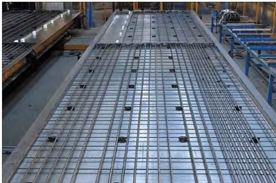
Точное позиционирование проставок гарантирует равномерное бетонирование. Это дает значительный потенциал экономии
