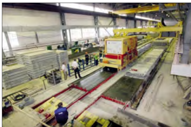
Рис. 1. Ввод в эксплуатацию после технического перевооружения универсального станда и формовочных столов 4×12 м с кантованием для выпуска конструкций сборно-монолитного каркаса с «НС» нового типа в ООО «Маскат», г. Астана, Казахстан. ЗАО «РЕКОН», Россия
