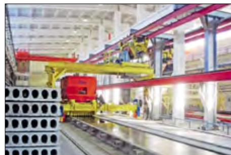
Рис. 4. Завод по производству конструкций сборно-монолитного каркаса с пустотным настилом. Одновременная работа в двух пролетах на универсальных стандах с двумя адресными подачами со слипформером и конусным вибробетоноукладчиком после техперевооружения, г. Пенза, ОАО «Механика». Все оборудование произведено ЗАО «РЕКОН», г. Чебоксары
