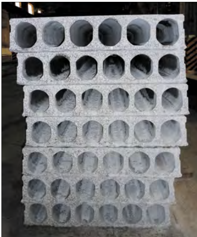
Геометрия плиты, отформованной на экструдере Nordimpianti на высочайшем уровне
