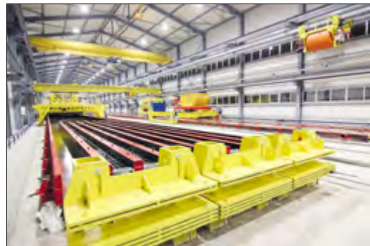
Рис. 9. Автоматизированный завод ЗАО «РЕКОН» с двумя универсальными стэндами, БСУ, адресной подачей, раздатчиком-накопителем длиной 18 м, мощностью 100 тыс. м 2 зданий сборно-монолитного каркаса с пустотным настилом. 2015 г., г. Советский, ХМАО. ООО «Атлант»
