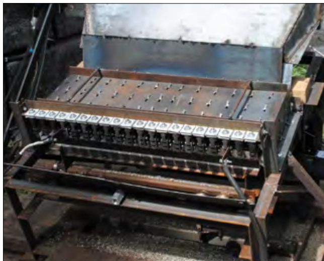
Рис. 1. Общий вид опытного образца электрической печи с вибрационной подовой платформой
