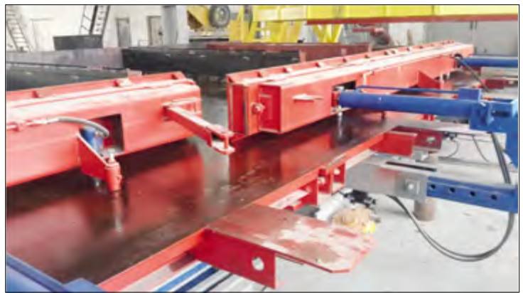
Рис. 7. Универсальный стэнд с автоматическим открыванием бортов, универсальным вибробетоноукладчиком с конусным бункером с поперечным и вертикальным перемещением с адресной подачей бетона по выпуску «НС», г. Хойники, Республика Беларусь; г. Чебоксары, Россия. ЗАО «РЕКОН». 2015 г.
