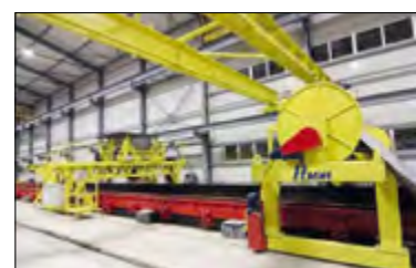
Рис. 6. Автоматизированный завод ЗАО «РЕКОН» с двумя универсальными стандами, БСУ, адресной подачей, раздатчиком-накопителем длиной 18 м, мощностью 100 тыс. м 2 в год зданий сборно-монолитного каркаса с пустотным настилом. 2015 г., г. Советский, ХМАО, ООО «Советский завод ЖБИ»
