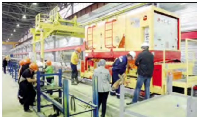
Рис. 2. Универсальный станд, адресная подача с редуктором-наполнителем и стандовой технологией пустотного настила. ЗАО «РЕКОН», г. Нефтекамск, Республика Башкортостан. 2014 г.
