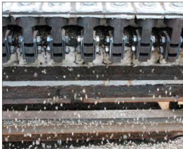
Рис. 2. Вид на модуль со стороны нижней части подвижного пода где происходит выход испаряемого материала
