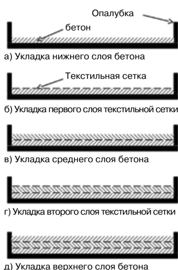
Рис. 1. Схема приготовления текстиль-бетона
