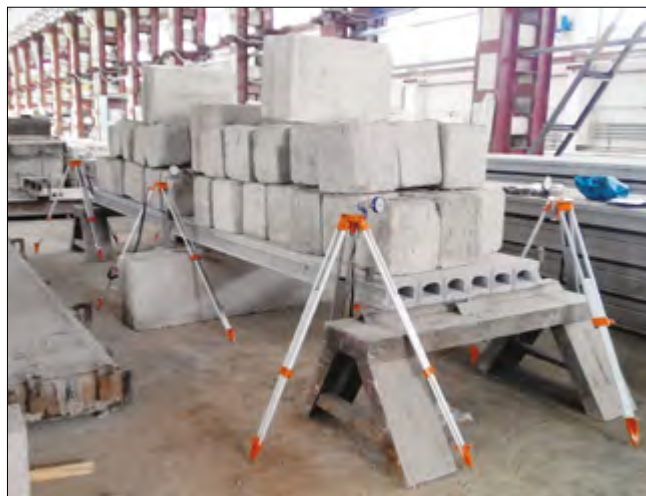
Рис. 4. Контрольные испытания плит: слева – загрузка плиты мелкими блоками, справа – наклонная трещина в опорной зоне
