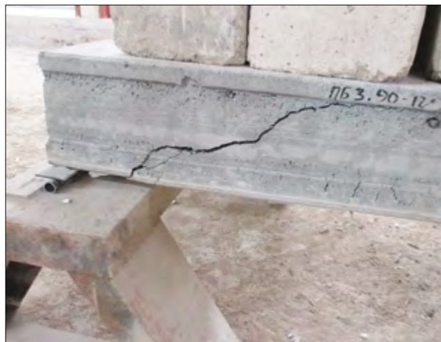
Рис. 4. Контрольные испытания плит: слева – загрузка плиты мелкими блоками, справа – наклонная трещина в опорной зоне
