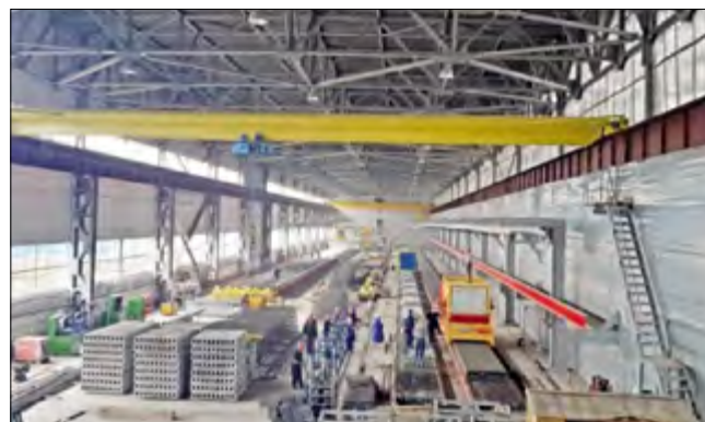
Рис. 2. Универсальный станд, адресная подача с редуктором-наполнителем и стандовой технологией пустотного настила. ЗАО «РЕКОН», г. Нефтекамск, Республика Башкортостан. 2014 г.
