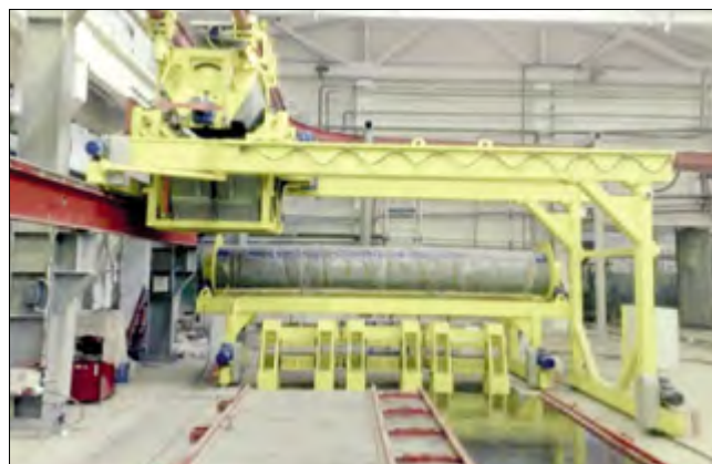
Рис. 5. Технологическое оборудование: автоматический накопитель-раздатчик, адресная подача, автоматический размотчик термопокрывала, универсальный станд с активной якорной станцией. ОАО «Железобетон», г. Саранск, Республика Мордовия. ЗАО «РЕКОН», г. Чебоксары. 2012 г.
