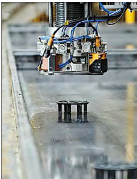
Роботизированная система Mesh Spacer осуществляет полностью автоматизированную укладку проставок
