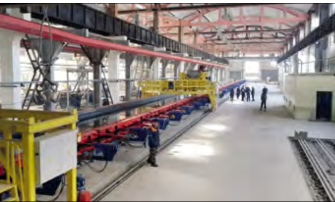
Рис. 7. Универсальный стэнд с автоматическим открыванием бортов, универсальным вибробетоноукладчиком с конусным бункером с поперечным и вертикальным перемещением с адресной подачей бетона по выпуску «НС», г. Хойники, Республика Беларусь; г. Чебоксары, Россия. ЗАО «РЕКОН». 2015 г.
