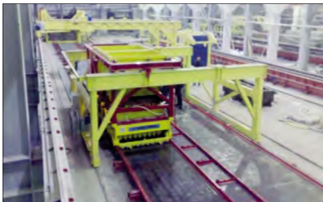
Рис. 4. Завод по производству конструкций сборно-монолитного каркаса с пустотным настилом. Одновременная работа в двух пролетах на универсальных стандах с двумя адресными подачами со слипформером и конусным вибробетоноукладчиком после техперевооружения, г. Пенза, ОАО «Механика». Все оборудование произведено ЗАО «РЕКОН», г. Чебоксары
