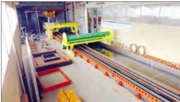
Рис. 11. Мини-ДСК мощностью 15–20 тыс м 2 общей площади каркаса зданий в год в составе БСУ, адресная подача, вибробетонукладчик, универсальный стэнд с сердечниками со встроенными магнитами, размотчик чехла с термопокрывалом, г. Чебоксары, ЗАО «РЕКОН». Срок исполнения 1,5 мес
