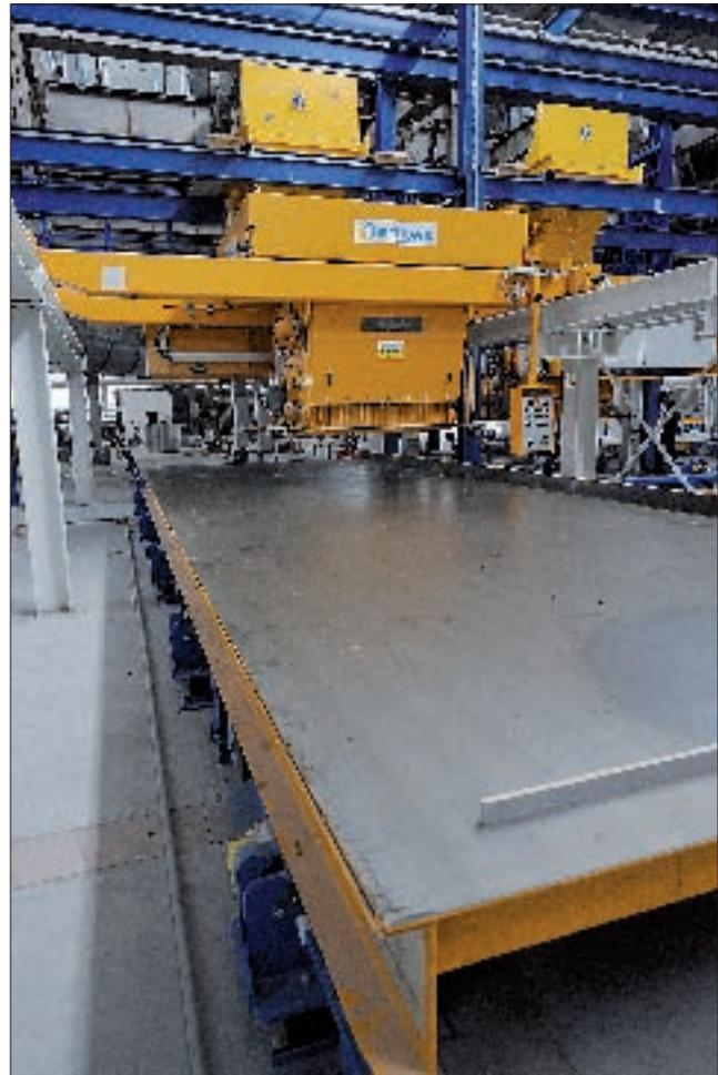
Рис. 2. Бетоноукладчик в агрегатно-конвейерной линии на ККПД
