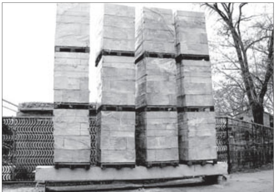
Рис. 6. Оценка несущей способности плиты из фибропеножелезобетона
