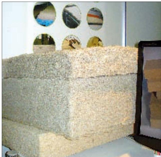
Теплоизоляционные материалы из льняного волокна имеют максимально достижимый класс безопасности (1а по NIBE) и высокие бактерицидные свойства
