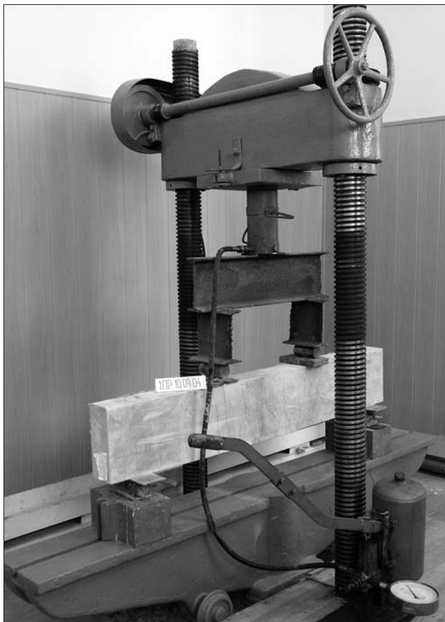
Рис. 5. Испытания фибропеножелезобетонных перемычек заводского изготовления
