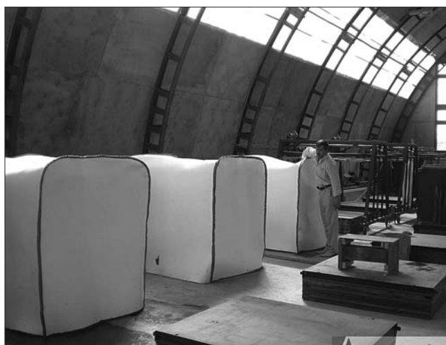
Рис. 4. Укрытие разрезанных массивов гидротермоколпаками
