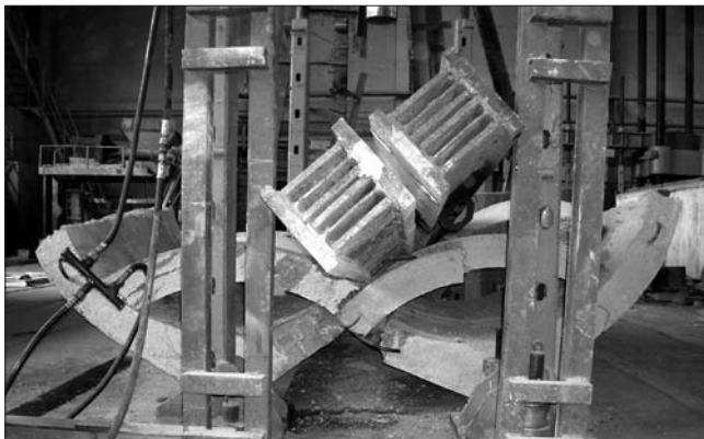
Рис. 3. Характер разрушения сталефибробетонной трубы с разрушением ключевого сечения по схеме чистого изгиба
