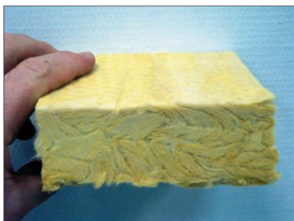
Рис. 1. Гофрированная структура теплоизоляционных плит ISOVER OL-P обеспечивает высокую прочность при сжатии при плотности 80 кг/м 3
