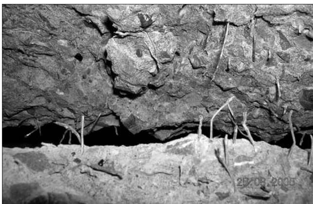
Рис. 5. Образец разрушенного сечения, армированного стальными волокнами
