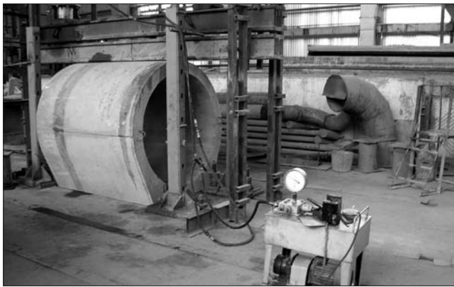
Рис. 2. Испытание сталефибробетонной трубы на стенде БашНИИСтроя
