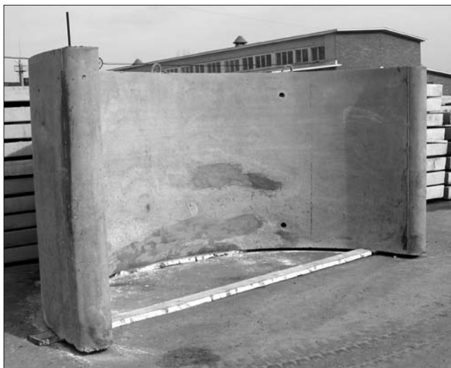
Рис. 8. Опытный образец двухшарнирной сталефибробетонной арки пролетом 4 м
