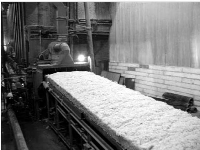
Рис. 1. Автоматизированная линия по производству минераловатных изделий «АКСИ»
