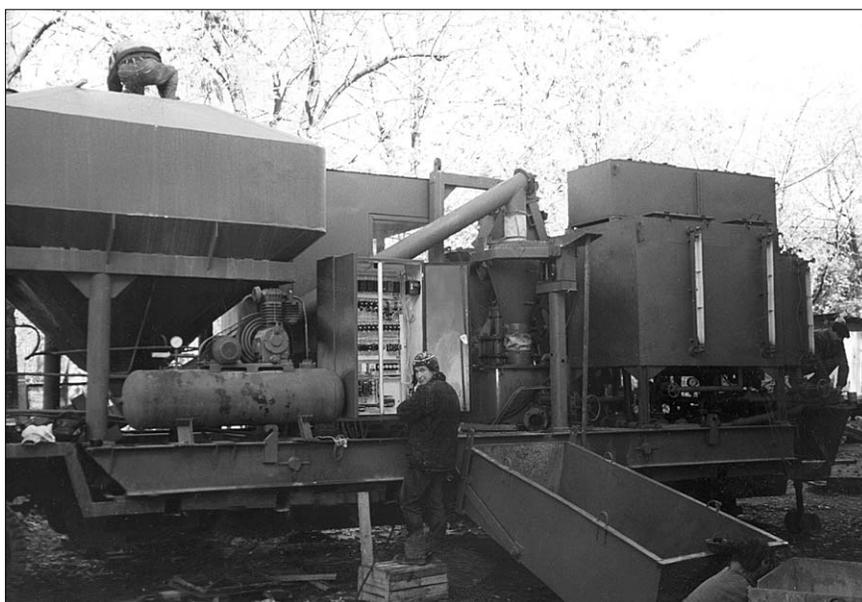
Мини-завод по производству пенобетона марки «Пеномонолит-500»
