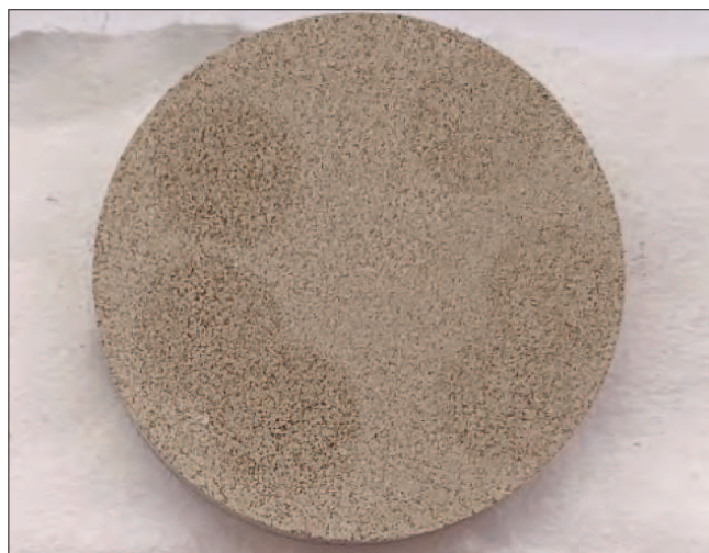
Рис. 1. Подготовленный образец-таблетка аспирационной пыли Fig. 1. Prepared sample-tablet of aspiration dust
