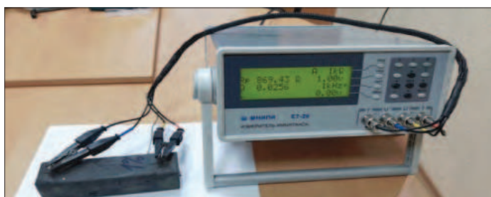
Рис. 3. Определение электропроводности образцов с помощью измерителя-иммитанса E7-20
