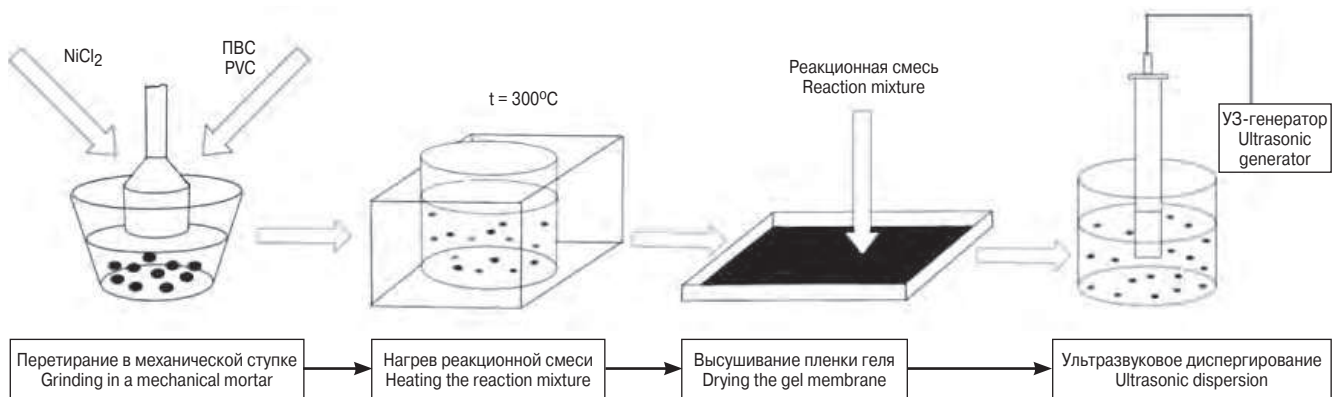
Рис. 1. Схема приготовления никельсодержащих углеродных наноструктур
