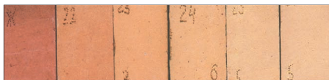
Рис. 1. Изменение цветовой гаммы образцов в зависимости от содержания TiO_2
