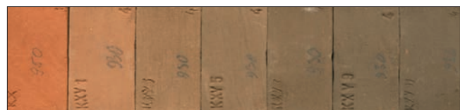
Рис. 3. Изменение цветовой гаммы образцов в зависимости от содержания марганцеворудного концентрата
