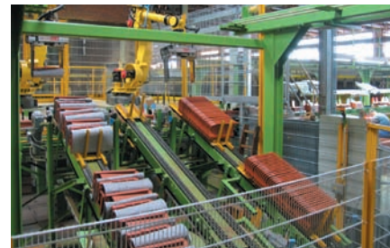
Системы автоматизации и использование роботов при производстве черепицы
