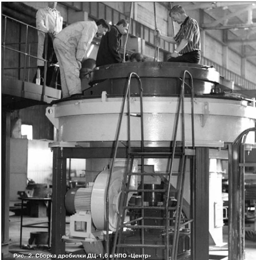
Рис. 2. Сборка дробилки ДЦ-1,6 в НПО «Центр»
