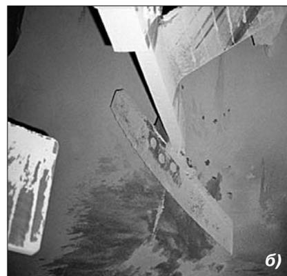
Рис. 10. Лопастей основной мешалки в форме: а) плуга; б) короткой ленты
