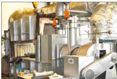
Экспериментальная печь с газовым отоплением
