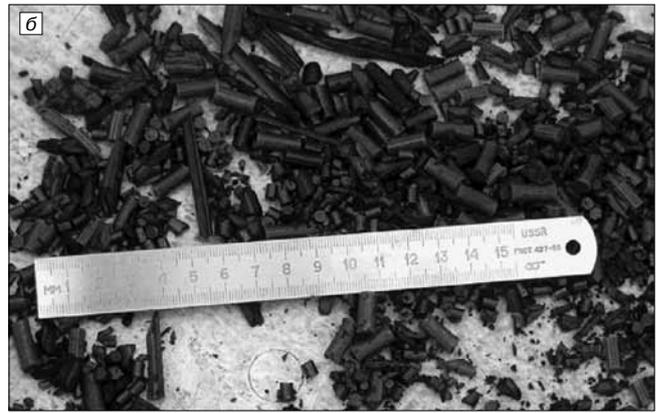
Рис. 1. Форма (а) и размер зерен (б) пироксилинового пороха в гранипоре
