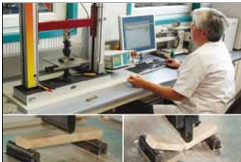
Устройство контроля предела прочности на изгиб, при сжатии и растяжении
