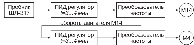
Рис. 4. Контур управления дымососом скруббера ШЛ-315
