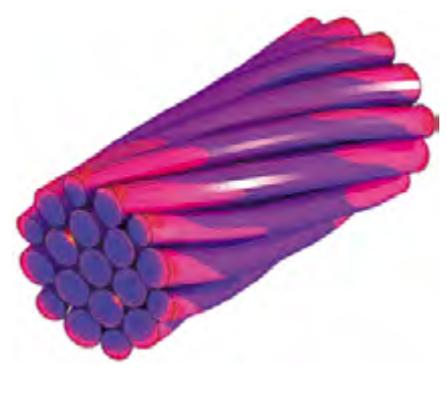
Рис. 7. Конечно-элементное моделирование нити материала с учетом крутки
