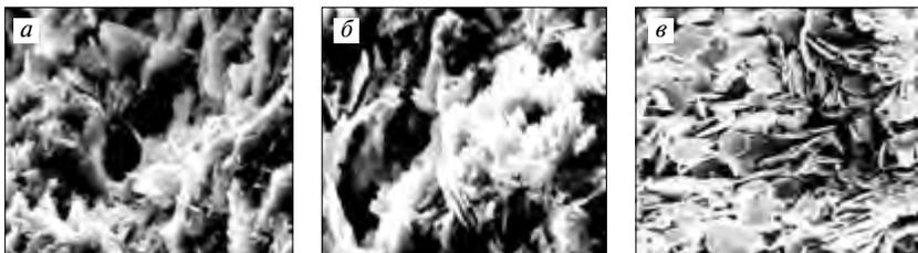
Поверхность гидратированного  $C_3A$ : а – с добавкой карбонатного микронаполнителя (10%), сканирующая электронная микроскопия ( $\times 3000$ ); б – с добавкой карбонатного микронаполнителя (10%), сканирующая электронная микроскопия ( $\times 4500$ ); в – без добавок, сканирующая электронная микроскопия ( $\times 3000$ )
