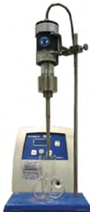
Рис. 1. Ультразвуковой кавитатор Bandelin Sonopuls HD 3200
