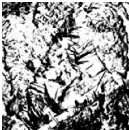
Рис. 3. Вид микроструктуры после бинаризации в программе ImageJ
