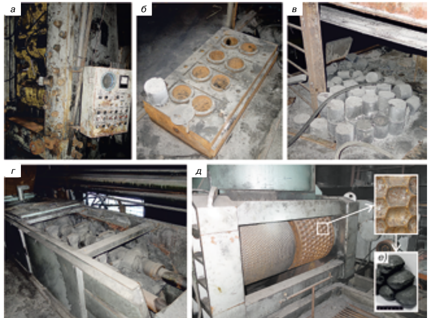
Рис. 3. Оборудование по выпуску топливных брикетов (текущее состояние): а – пресс СМ-1085Б; б – кирпичная пресс-форма, переоборудованная под выпуск цилиндрических коксовых брикетов диаметром 90 мм (в); г – горизонтальный лопастной смеситель; д – брикетировующий пресс ARP-50 фирмы Acan Machine; е – капсулированные угольные брикеты 80×50×40 мм
