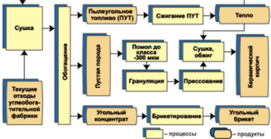
Рис. 4. Технологическая схема производства керамического кирпича и угольных брикетов из отходов углеобогащения ЦОФ «Абашевская»
